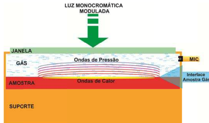
Figura 5.8 – Diagrama da geração de ondas de pressão (sinal sonoro) com frequência de modulação FM no interior de uma célula fotoacústica fechada.
