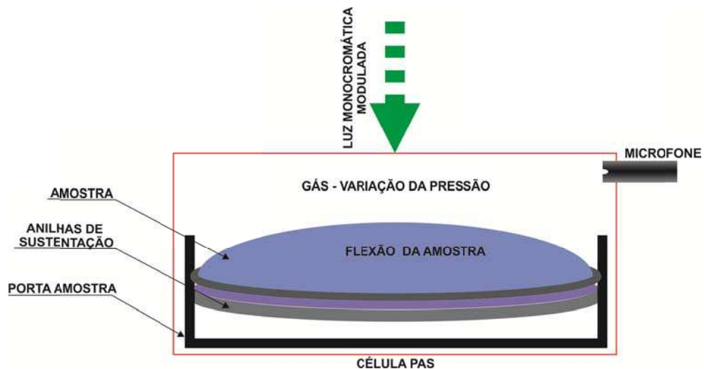
Figura 5.6 – Flexão termoelástica da amostra
