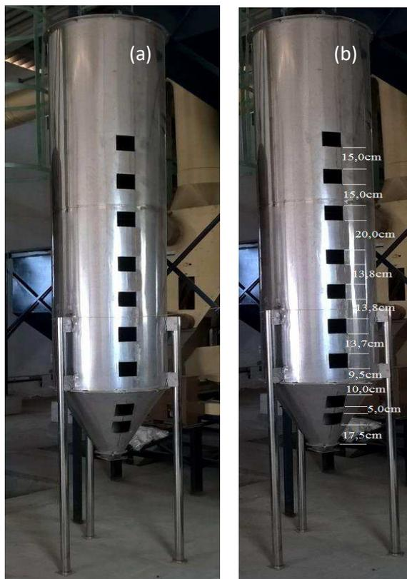
A seção de parede extraída foi reintegrada ao silo sendo fixada pelas células de carga a uma haste horizontal chamada de haste secundária e as hastes secundárias por sua vez, estiveram fixadas a uma haste central vertical.
