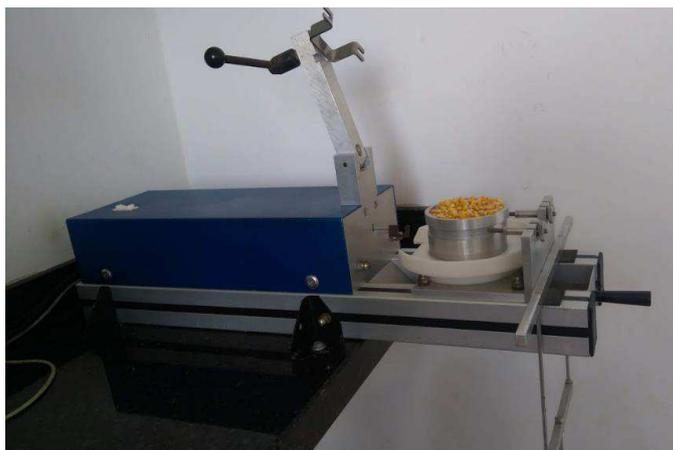
A homogeneização e adensamento da amostra se deu por meio de “*twisters*” que consistem em aplicar uma tensão previamente conhecida na amostra com movimentos circulares em 90°. Antes do cisalhamento propriamente dito, a amostra é pré-cisalhada com o mesmo valor de tensão na qual ela foi homogeneizada (MADRONA & CALIL JR., 2009).
