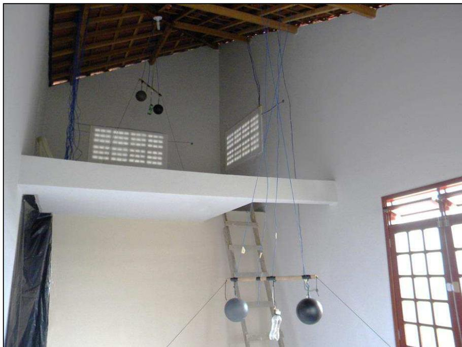
Figura 22- Conjuntos de sensores de temperatura, na sala e no mezanino
