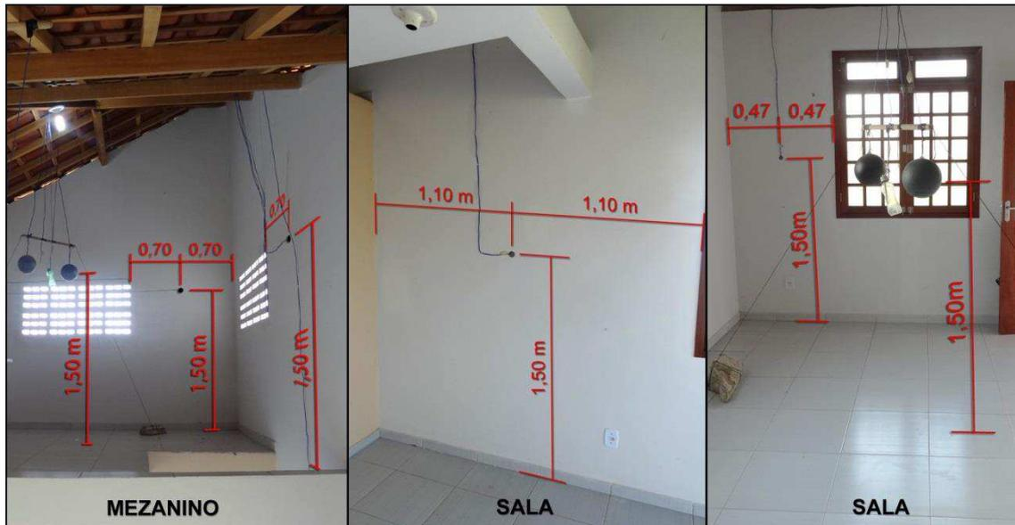
Figura 24- Localização dos sensores para medição de temperatura superficial de paredes
