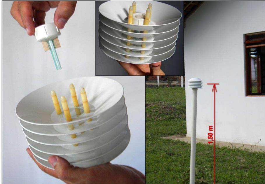
Figura 21- Abrigo para sensor de medição da  $t_{bs}$  exterior
