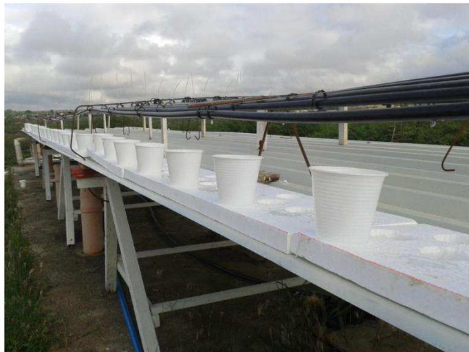
Figura 3. Sistema de coleta dos volumes de água simultâneo em todos os gotejadores
