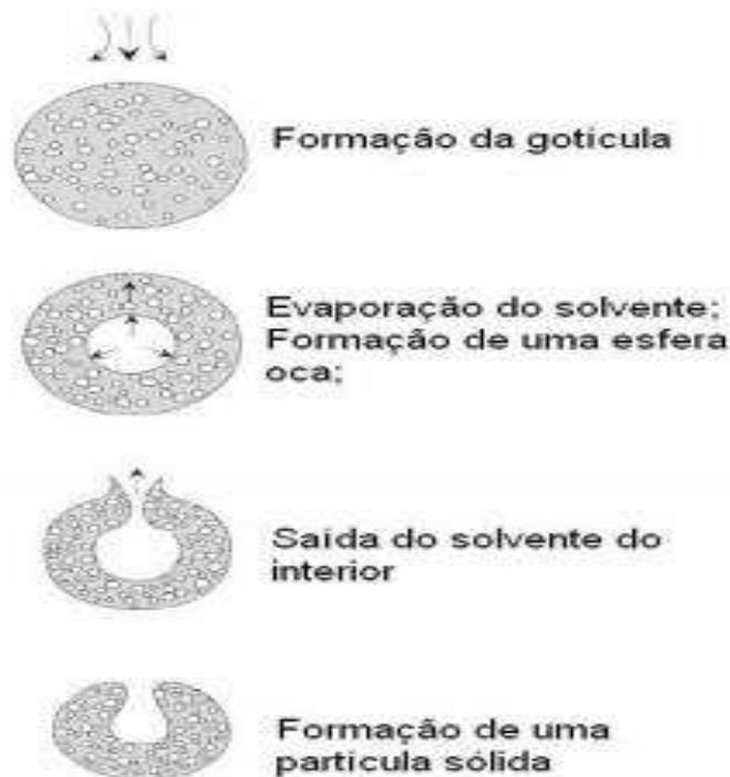
**Figura 2.3** – Esquema da formação de uma partícula sólida na secagem por aspersão (CAO et al., 2000)
