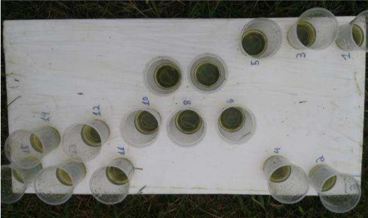
**Figura 10. Placa de poliestireno com encaixe para 15 copos coletores de volume para coleta simultânea**
