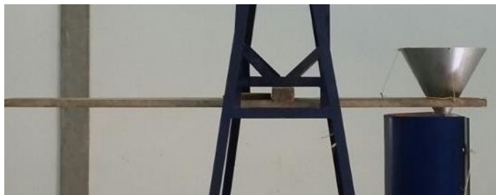
Figura 19. Sistema de carregamento do silo.
