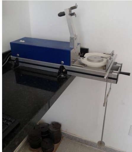
Figura 28. Jenike Shear Cell, utilizado para determinação das propriedades de fluxo.
