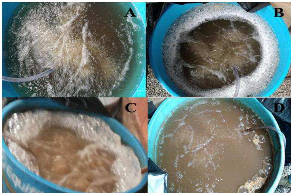
**Figura 5.** Evolução do aspecto da água da caixa, durante o período experimental. (A) Água no 9º dia, ainda transparente e levemente esverdeada. (B) No 17º dia a água estava começando a apresentar aspecto amarronzado. (C) No 29º dia, formação da espuma na superfície e grande quantidade de limo aderido à parede da caixa. (D) Redução da quantidade de espuma e aparecimento dos bioflocos em suspensão, por volta do 38º dia.
