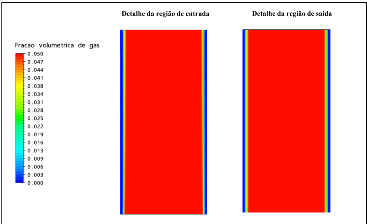
Figura 4.11: Campo de fração volumétrica do gás (ar) ao longo da tubulação no plano YZ, referente ao caso 18.
