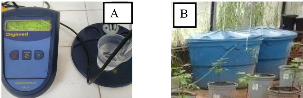
Figura 04. (A) Condutivímetro de bancada para leitura da Condutividade Elétrica (CE) da água de Brrrigação, (B) Caixas de água para armazenamento de água diluída com água da chuva e água salinizada para a irrigação. Campina, PB, Grande, 2015.
