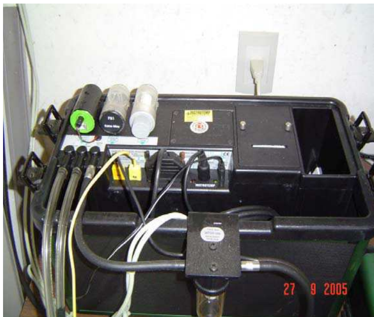
Figura 3.24 – Analisador de gases. Fonte: Próprio autor (2005).
