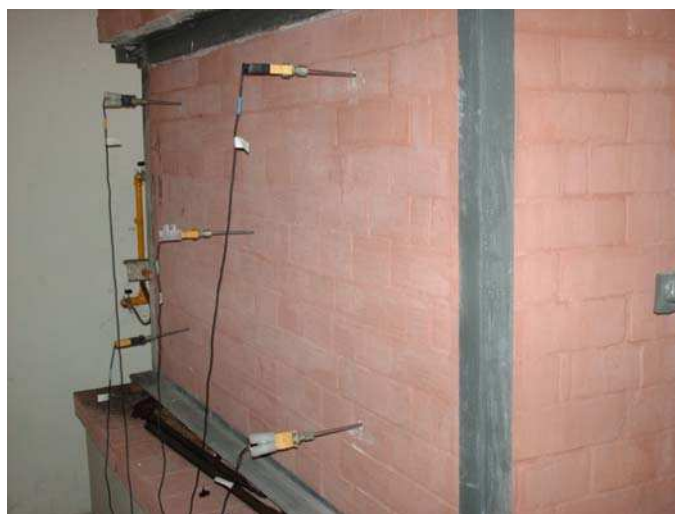
Figura 3.16 – Vista lateral esquerda com os termopares instalados no forno. Fonte: Próprio autor (2007).
