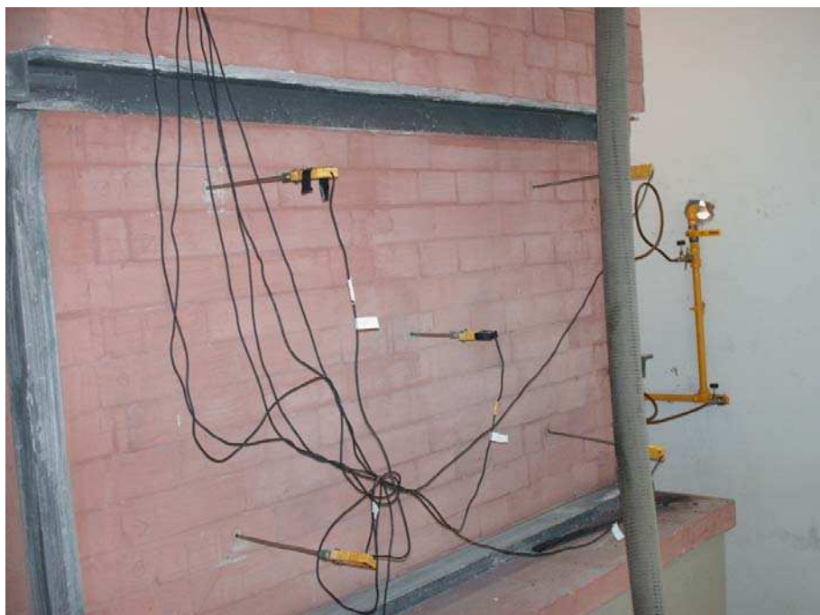
Figura 3.19 – Vista lateral direita com os termopares instalados no forno. Fonte: Próprio autor (2007).
