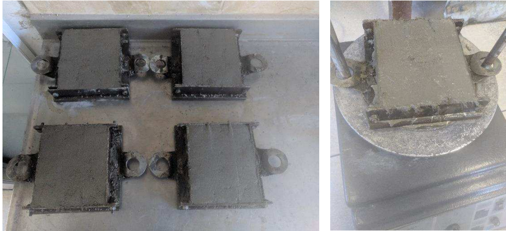
Figura 8. Corpos de prova após moldagem e durante o processo de vibração. Fonte Arquivo pessoal.
