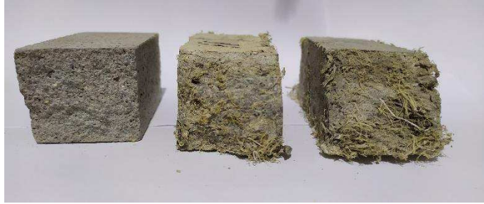
Figura 11. Corpos de prova com adição de 0%, 2% e 3%. Fonte: Arquivo pessoal.
