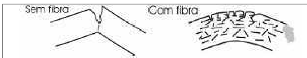
Figura 4. Comportamento do compósito durante a ruptura. Fonte: Silva et al., 2014.
