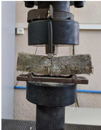
Figura 10. Ensaio de resistência a tração na flexão de 3 pontos.
