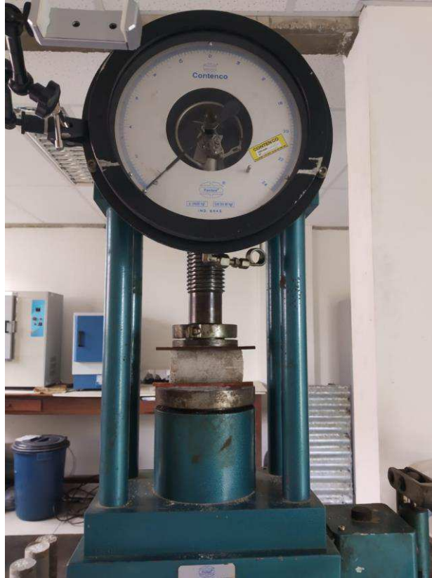
Figura 14. Ensaio de Resistência à tração por compressão diametral
