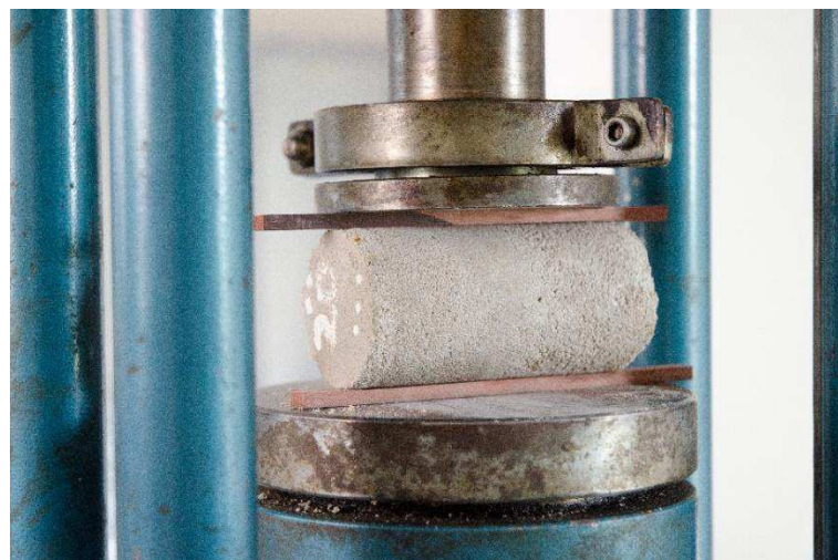
Figura 15. Rompimento de corpo de prova à tração por compressão diametral
