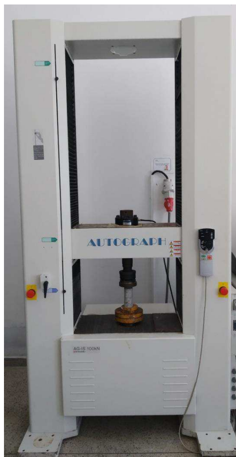
Figura 13. Ensaio de Resistência à compressão simples
