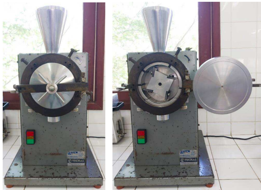
Figura 3. Moinho de facas utilizado para moagem do polímero
