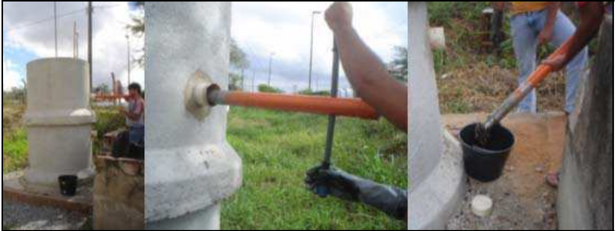
Figura 55 – Amostrador utilizado na coleta de sólidos.
