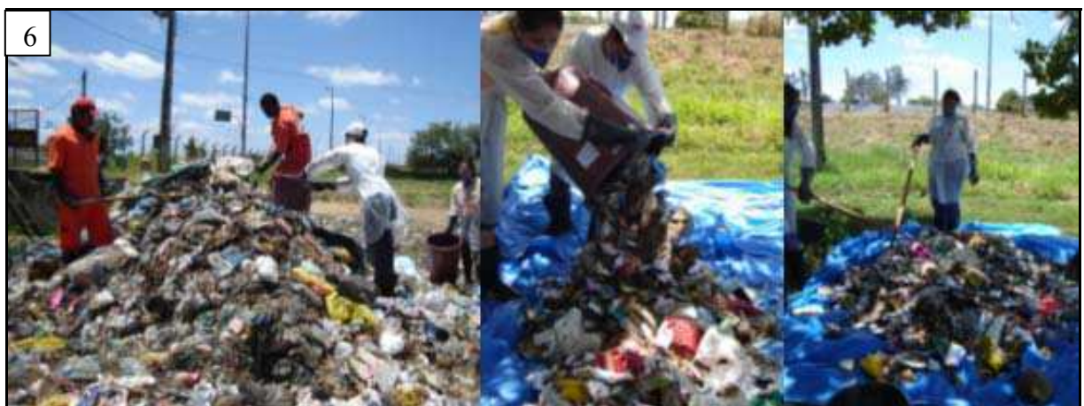
Figura 47 - Seleção e homogeneização dos resíduos destinados à caracterização.
