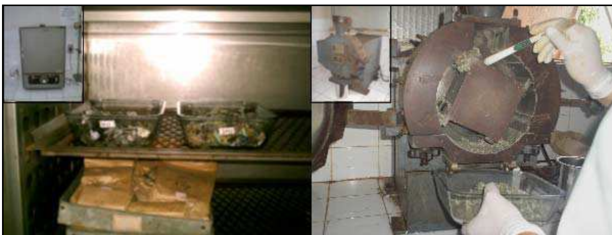
Figura 65 - Amostra e estufa e processada em moinho de bolas.
