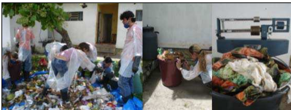
Figura 51 - Etapas para determinação da composição gravimétrica dos RSU de Campina Grande.
