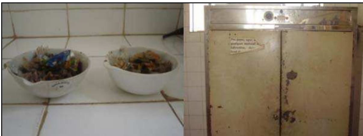
Figura 50 – Determinação do teor de umidade dos resíduos.
