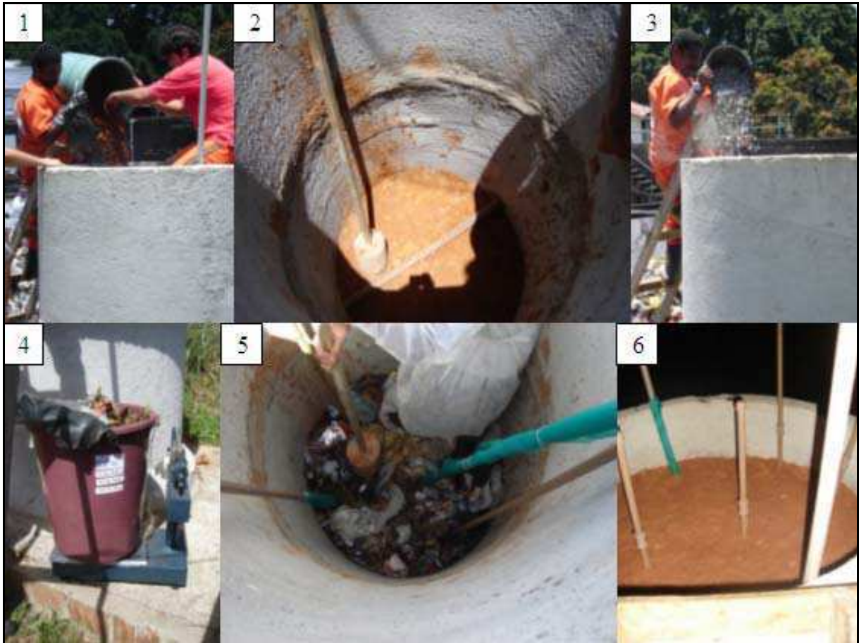
Figura 53. Etapas de preenchimento do lisímetro.
