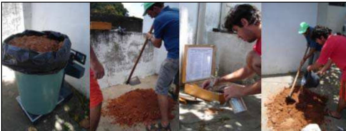
Figura 52 - Determinação do teor de umidade natural do solo e acréscimo de água para atingir a umidade ótima.
