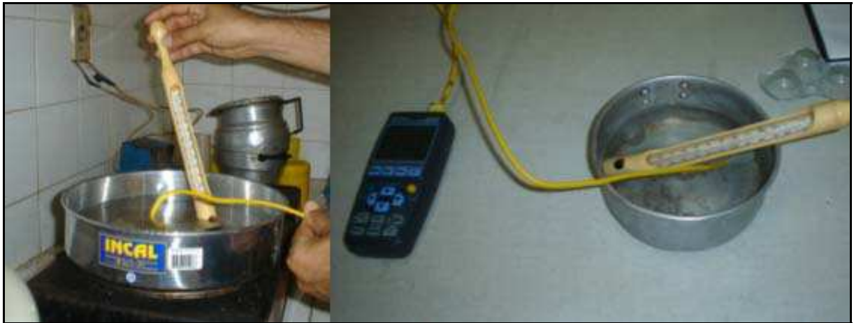
Figura 28 – Detalhe da calibração da corrente emitida pelo termopar em função da temperatura da junção.
