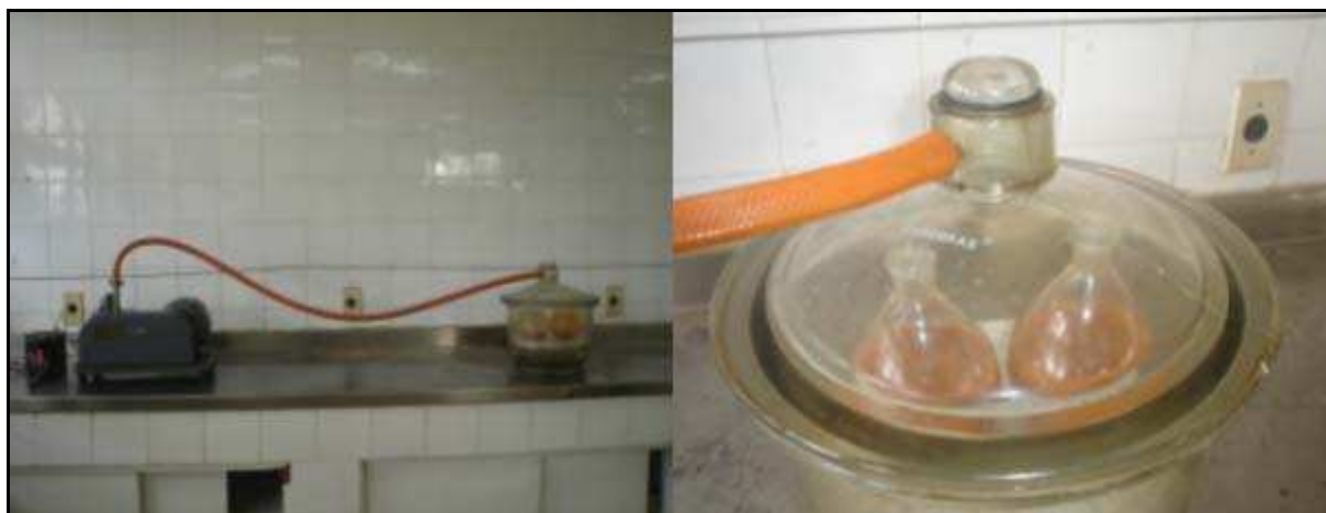
Figura 33 - Ensaio para determinação da massa específica dos grãos.
