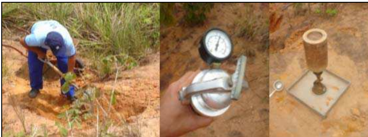
Figura 32 - Determinação do teor de umidade e massa específica durante a extração do solo.
