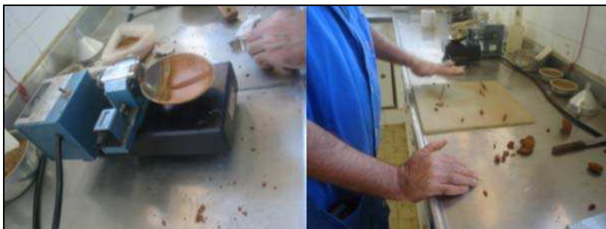
Figura 35 - Ensaios para determinação do limite de liquidez e plasticidade.
