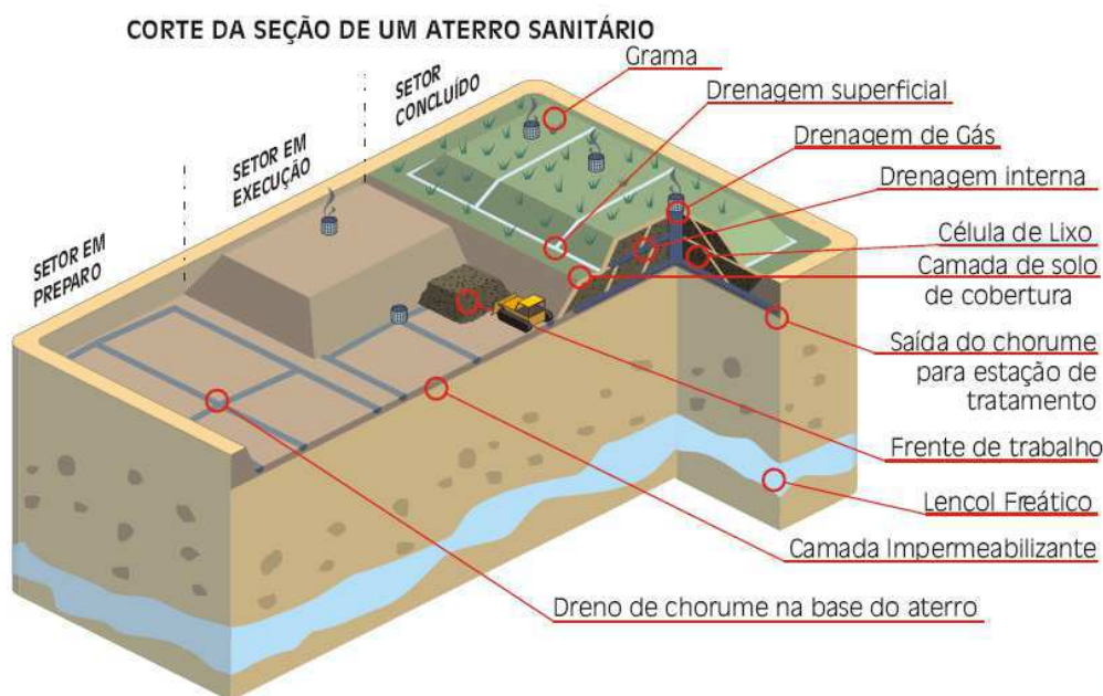
Figura 4 - Corte da seção transversal de um aterro de RSU (MANUAL DE OPERAÇÃO DE ATERROS SANITÁRIOS, 2007).
