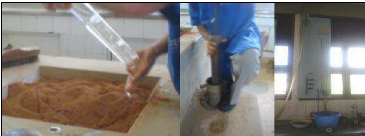
Figura 36 - Ensaios para determinação do coeficiente de permeabilidade e compactação.
