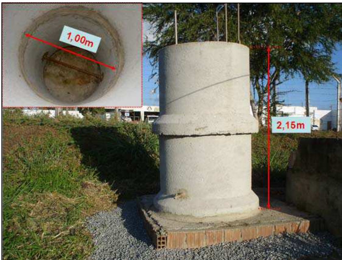
Figura 18 - Célula experimental (Lisímetro).
