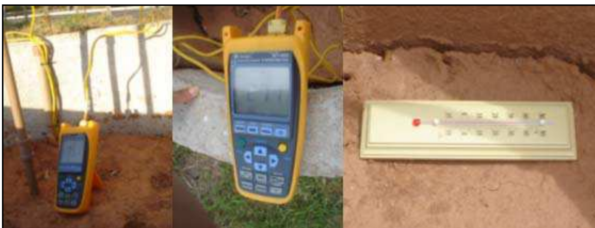
Figura 68 – Medição de temperatura interna (termopares) e externa.
