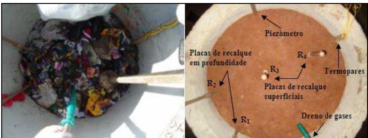
Figura 54 - Detalhe da instalação da instrumentação ao longo do preenchimento do lisímetro e na fase final.
