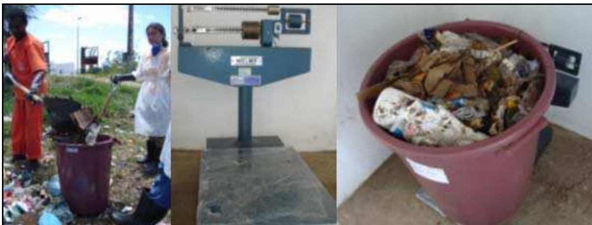
Figura 49 – Determinação da massa específica aparente solta dos resíduos.
