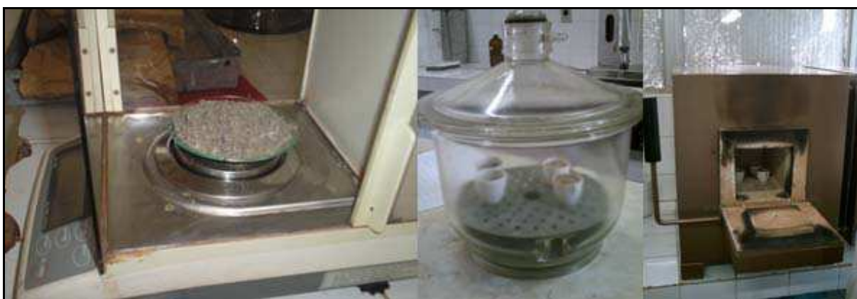
Figura 67 - Determinação do teor de matéria orgânica e de carbono.
