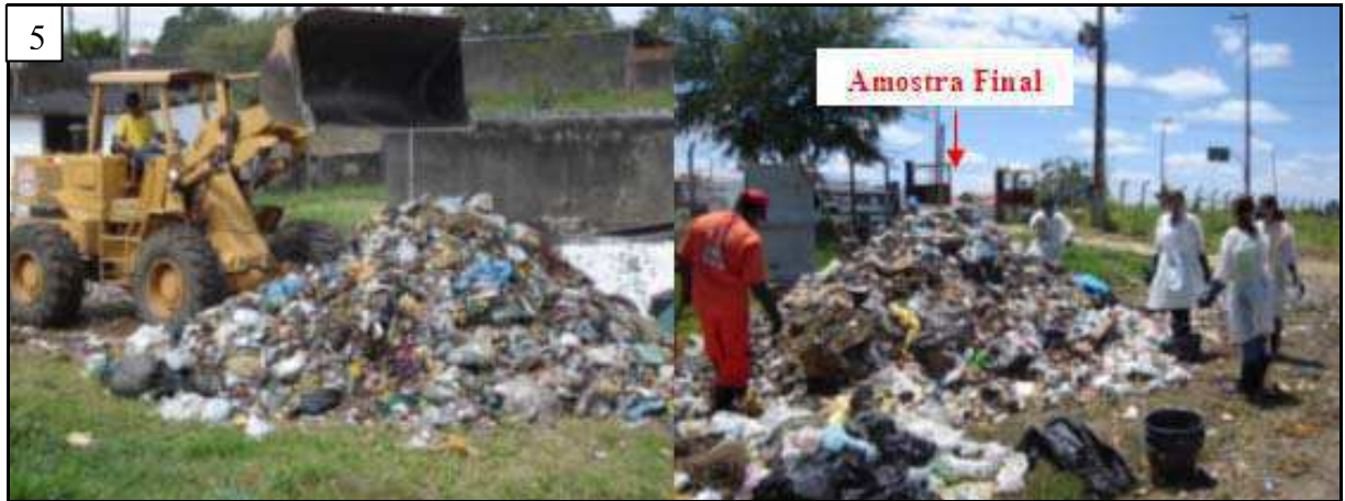
Figura 45 - Amostra final resultante do processo de homogeneização e quarteamento.
