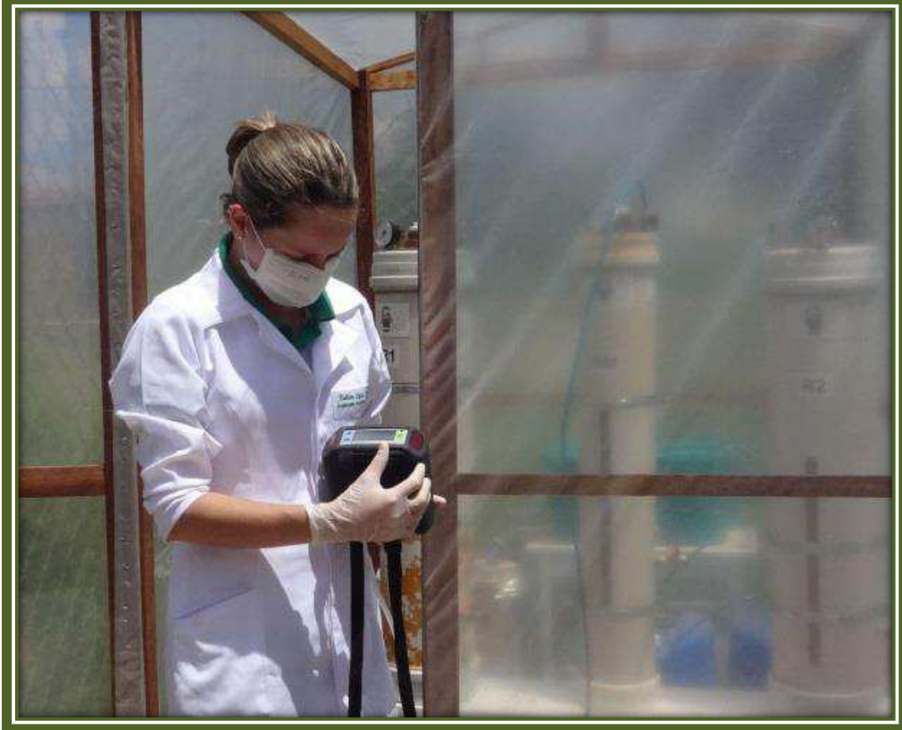
Figura 31: Leitura das concentrações dos gases através do equipamento Drager
