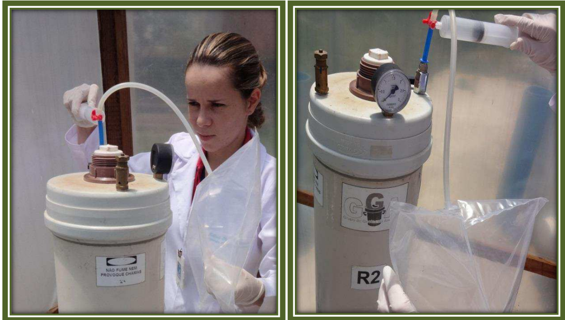
Figura 29: Realização da Coleta do Biogás nos Biorreatores
