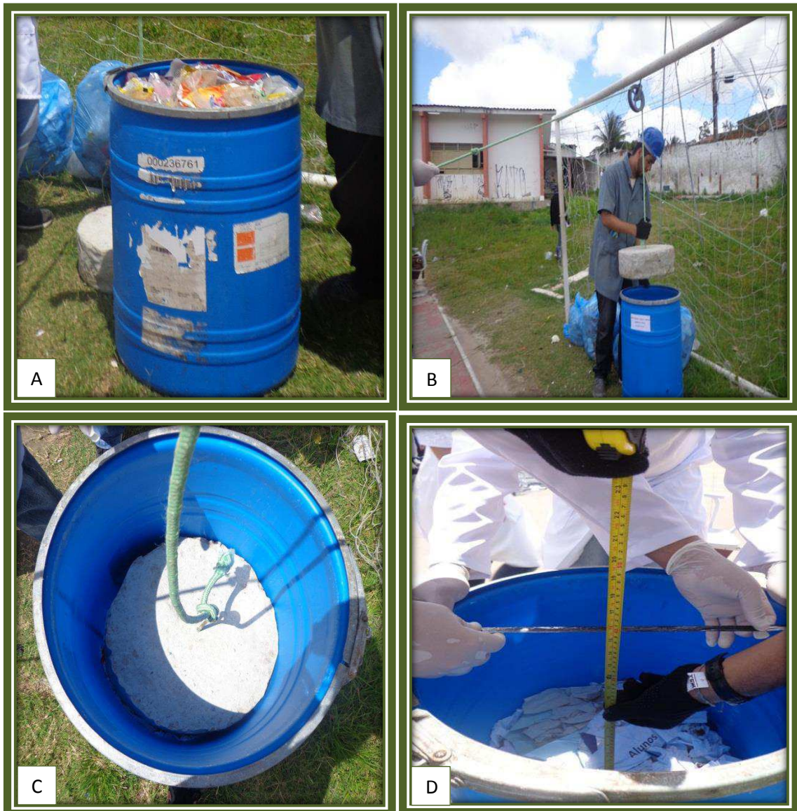
Figura 17: (A) Composição volumétrica dos resíduos, (B) compactação dos resíduos, (C) resíduos compactados e (D) medição da altura dos resíduos
