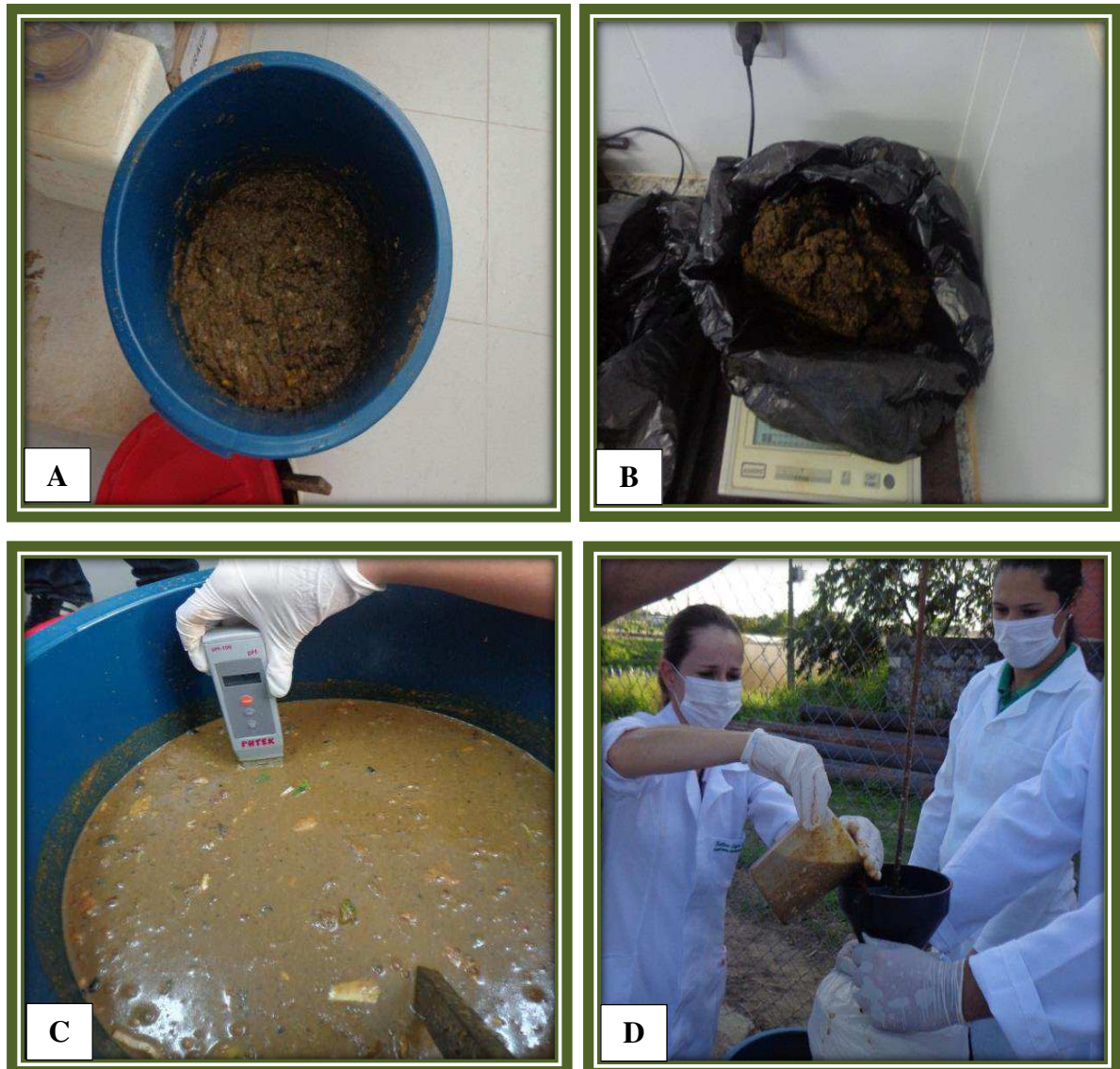
Figura 19: (A) Amostra de matéria orgânica triturada, (B) esterco bovino (inóculo), (C) mistura dos resíduos (matéria orgânica + esterco + água) e (D) enchimento dos biorreatores
