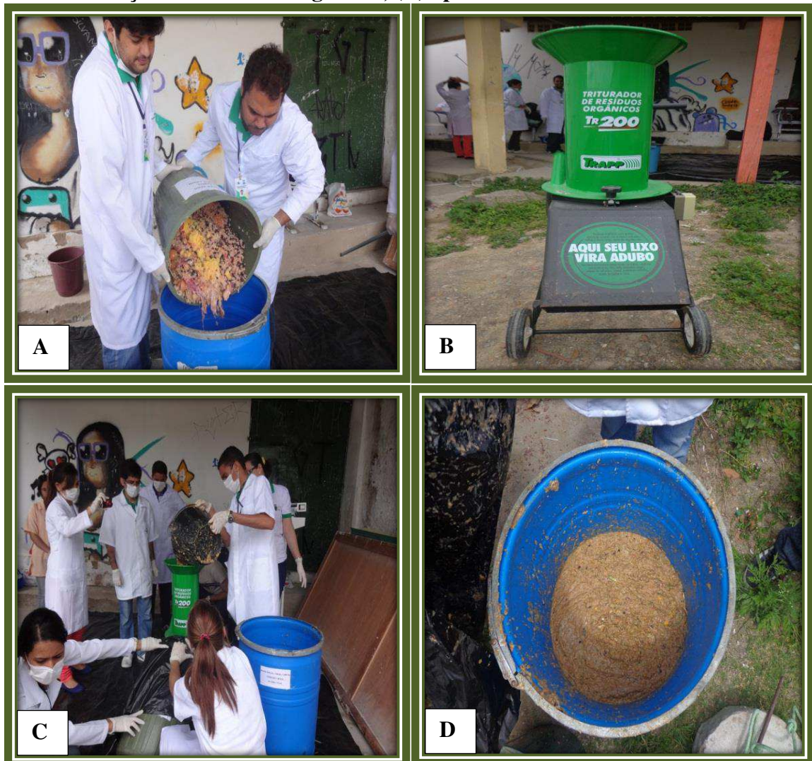
Figura 18: (A) Resíduos orgânicos, (B) triturador de resíduos orgânicos TR 200, (C) trituração dos resíduos orgânicos, (D) aparência dos resíduos triturados
