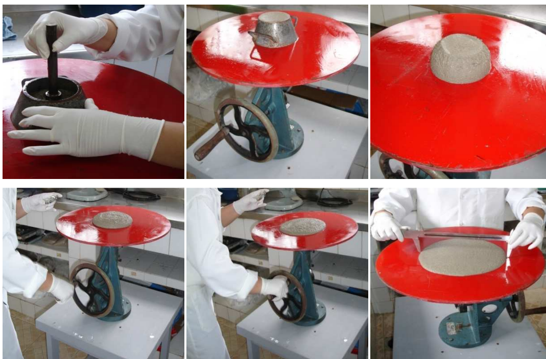
Figura 3.7 – Procedimentos para determinação do índice de consistência
