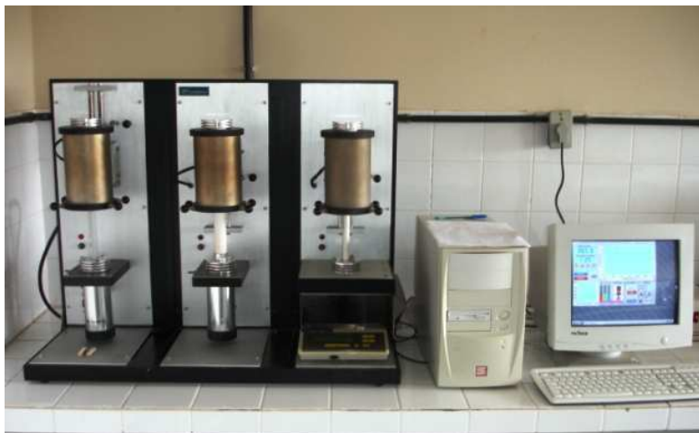
Figura 3.2 – Aparelho utilizado para determinação das análises térmica diferencial e termogravimétrica
