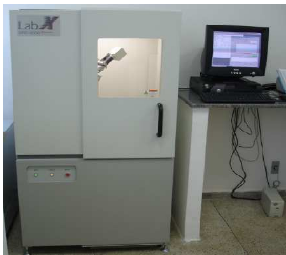
Figura 3.4 – Difratorômetro de raios-X SHIMADZU XRD - 6000
