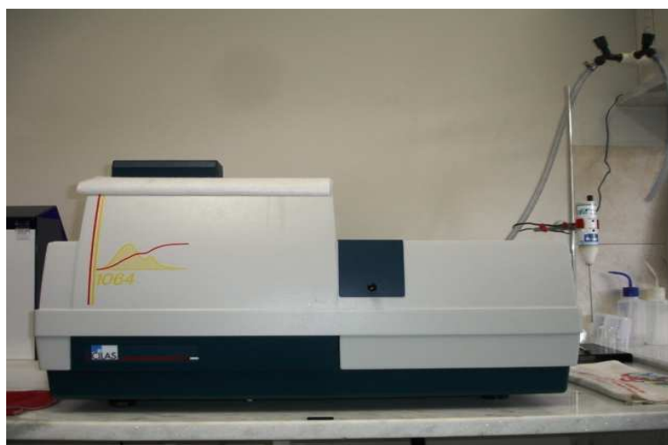
Figura 3.5 – Equipamento do ensaio de granulometria por difração a laser – CILAS 1064
