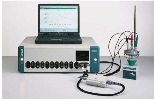
Figura 7- Potenciostato/Galvanostato PG STAT 302N.
