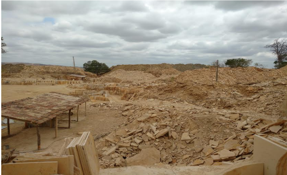
Figura 3. Amontoados de entulhos formados pelo descarte no meio ambiente do município de Nova Olinda - Ceará, do rejeito das atividades de lavra da Pedra Cariri.
