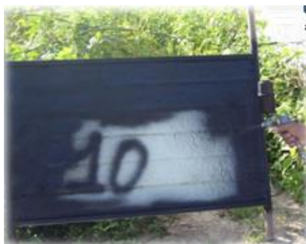
Figura 6. Processo de pintura da placa de PVC.
