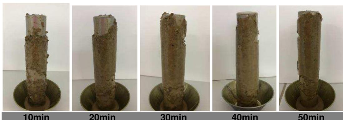
Figura 21. Acreção dos *pellets* com utilização do fluido F2 (com KCl).
