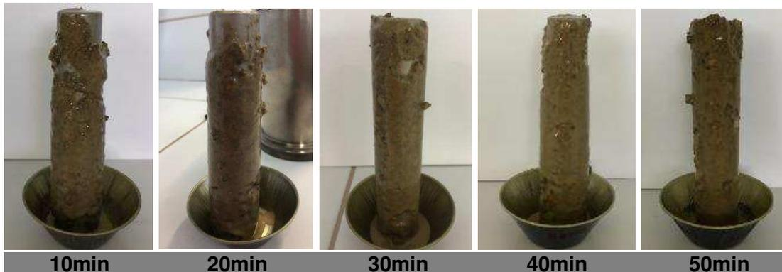
Figura 20. Acreção dos *pellets* com utilização do fluido F1 (sem inibidor).
