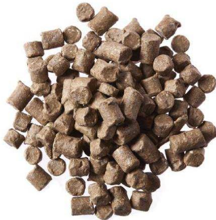
**Figura 3.** Bentonita em forma de grãos, ou *pellets*.
