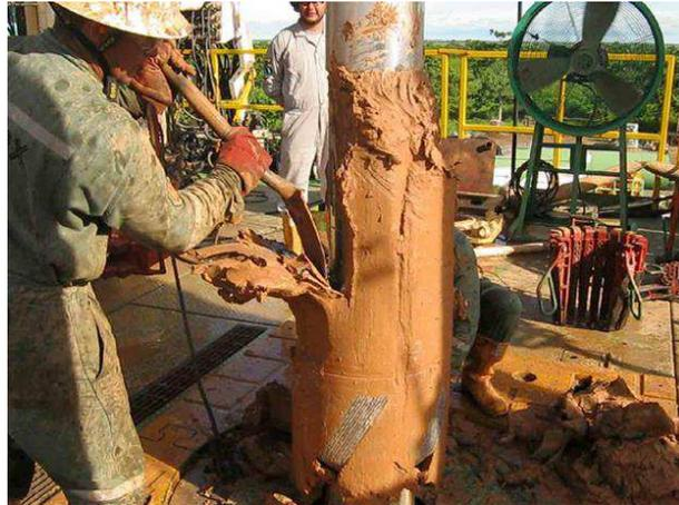
**Figura 9.** Acreção nos componentes da coluna de perfuração (Palazzo, 2020).
