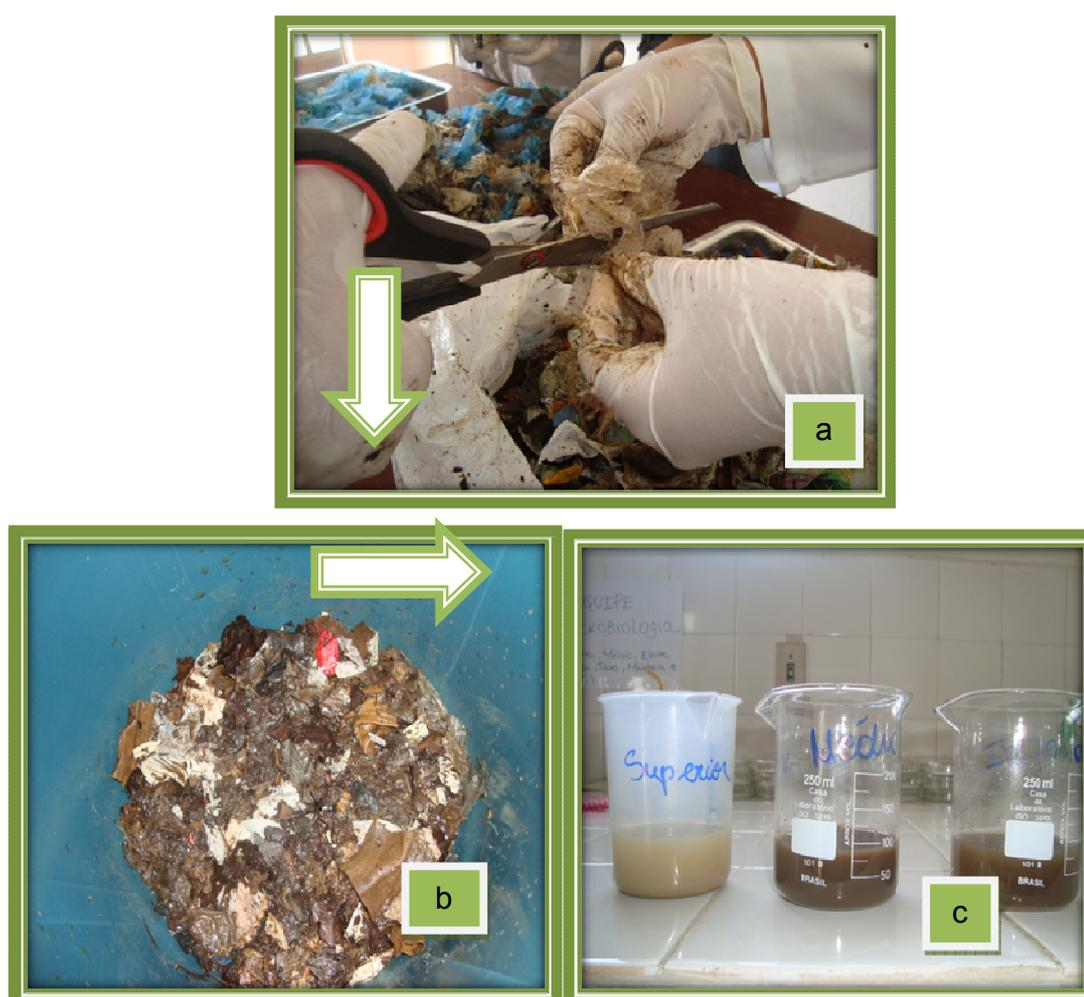
Figura 33 (a), (b) e (c): Amostras sendo picotadas, resíduos em repouso e extrato obtido
