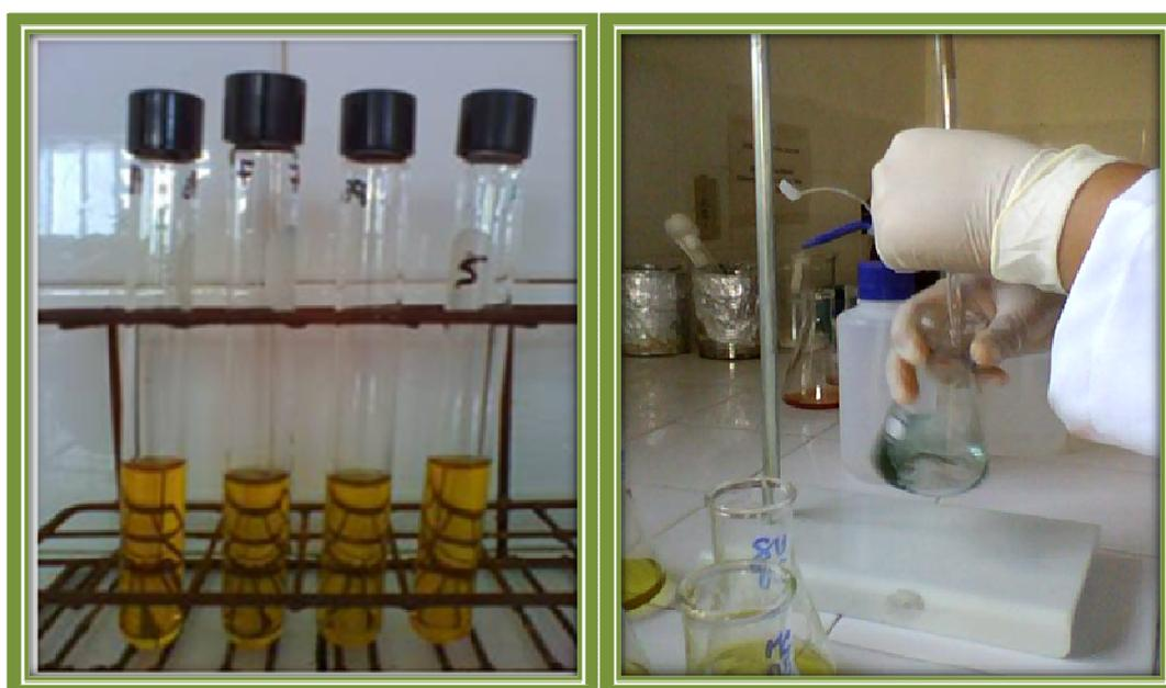
**Figura 38: Determinação da DQO**
