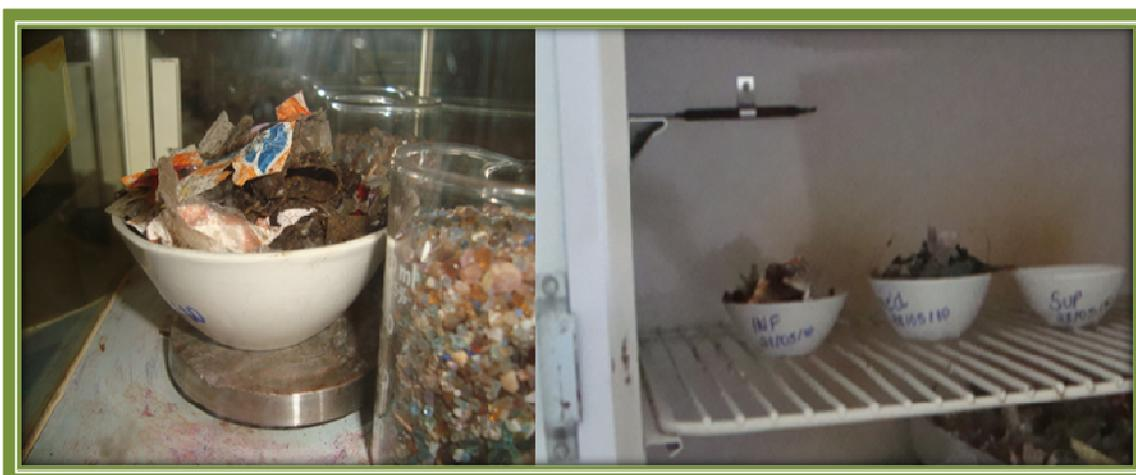
Figura 27: Determinação do teor de umidade
