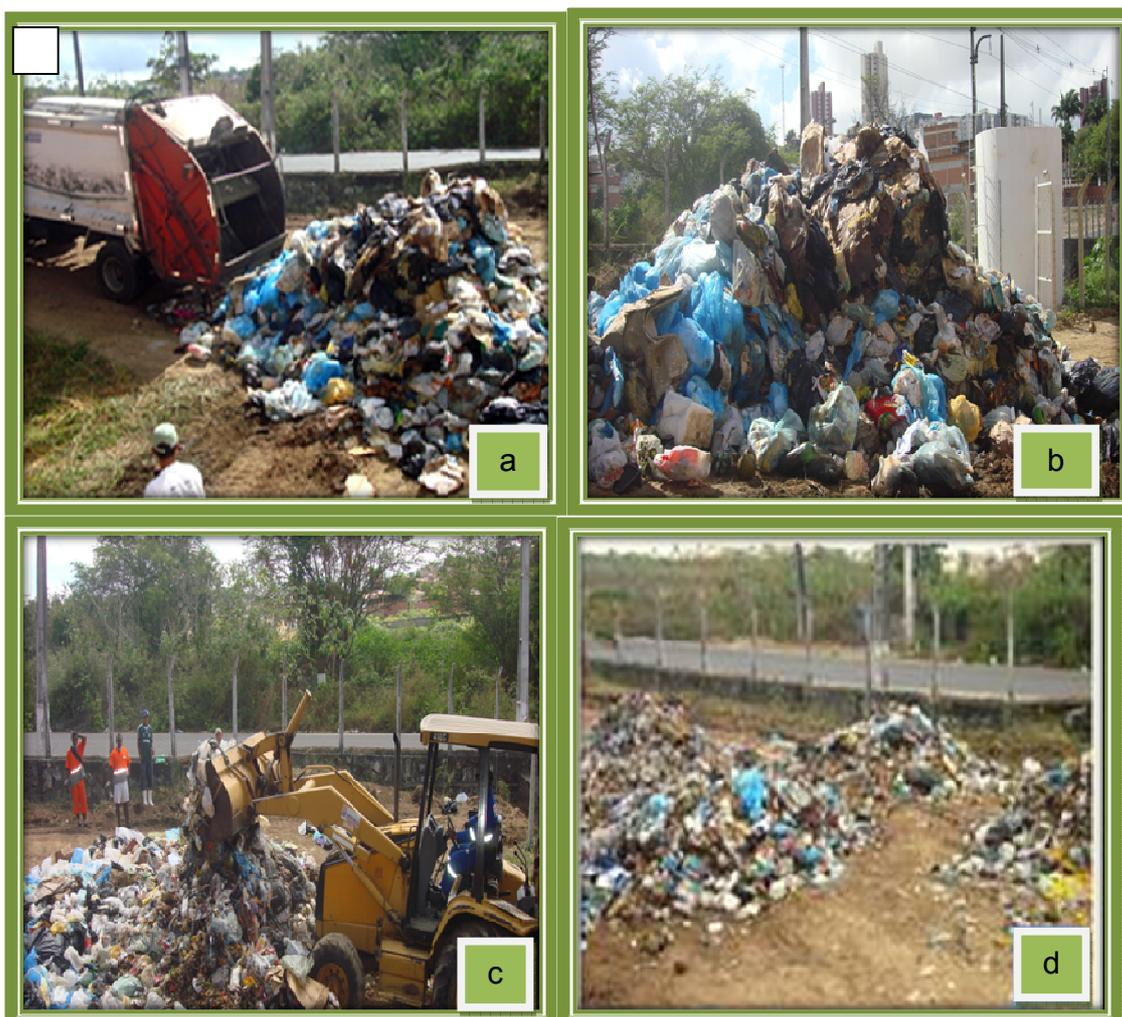
Figura 25 (a), (b), (c) e (d): Descarregamento, Homogeneização, formação da pilha e quarteamento das amostras de resíduos, respectivamente
