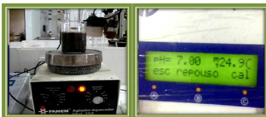
Figura 34: Determinação do pH
