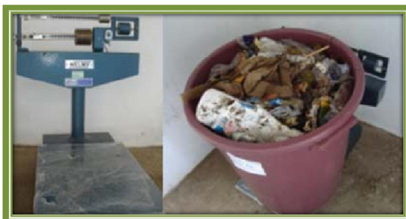
Figura 26: Determinação da massa específica solta dos RSU
