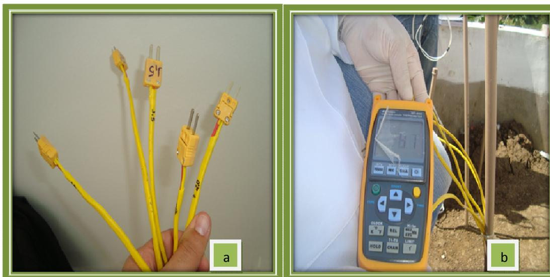
Figura 20: (a) Termopares do tipo K e (b) termômetro elétrico
