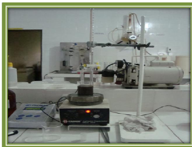
**Figura 36: Determinação da alcalinidade**
