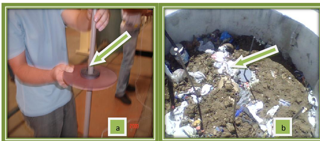
Figura 18 (a) e (b): Placas de recalque
