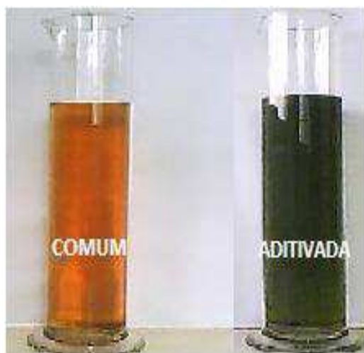
Figura 12. Análise do aspecto visual da cor e aparência de duas amostras de gasolina tipo C.
