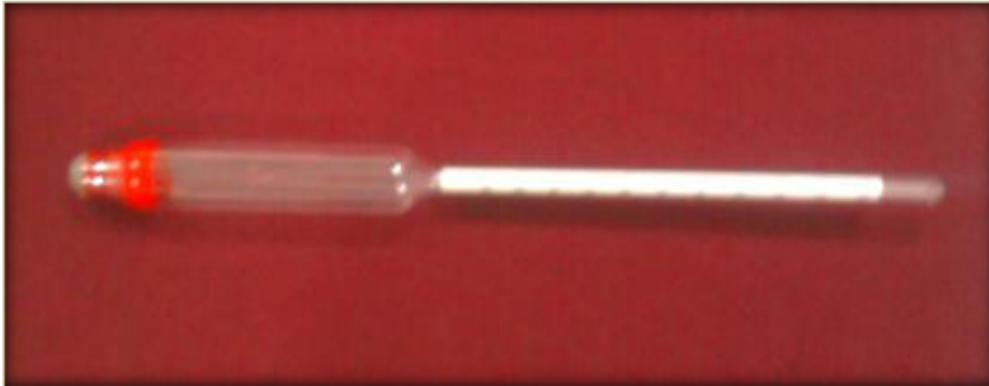
Figura 14. Medidor de massa específica de graduação 0,700 a 0,800 g/mL.
