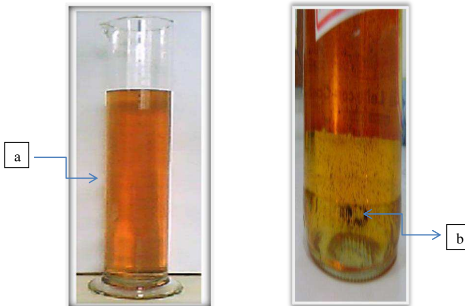
Figura 13. Amostra da gasolina sem impureza (a) e com impureza (b).
