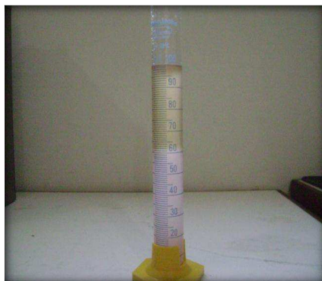
Figura 18. Teste de teor de AEAC realizado no LEMT.
