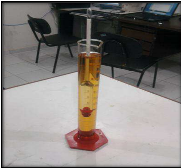
Figura 15. Determinação da massa específica em uma amostra no LEMT.
