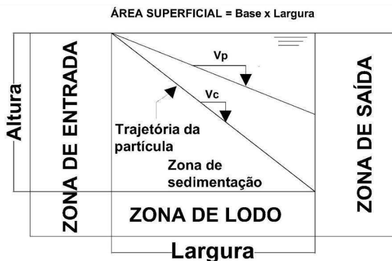
Figura 2.6: Comportamento da sedimentação em um tanque de decantação ideal.
