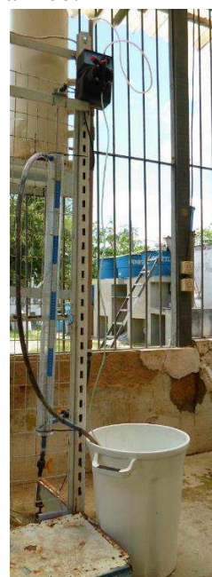
Figura 3.14: Representação visual da coluna de decantação utilizada no método dinâmico.
