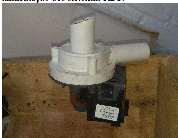
Figura 3.2: Bomba utilizada para alimentação dos sistemas RBS.
