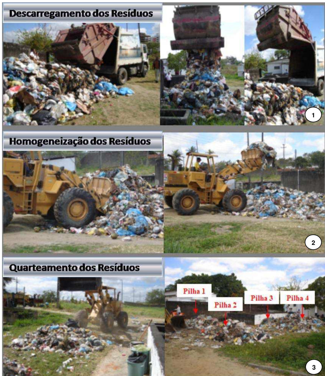
Figura 17: Descarregamento (1), homogeneização do material (2) e divisão das pilhas(3).
