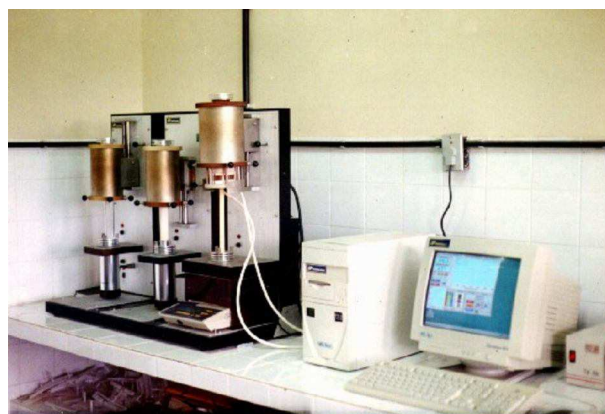
Figura 3.8: Analisador térmico RB 3000.
