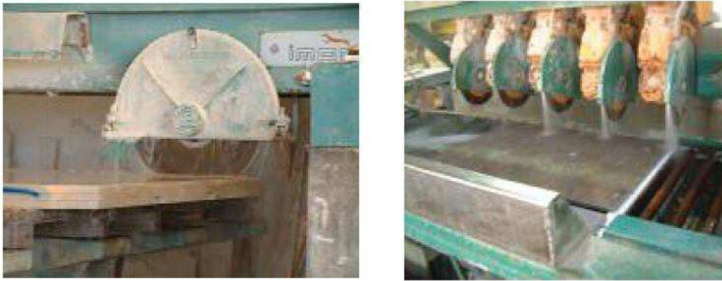
Figura 2.2: Discos cortantes de concreção diamantada. (a) máquina monodisco (b) máquina multidisco (Fonte: OLIVEIRA, 2005).
