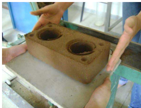
Figura 3.10: Prensa manual modular SAHARA, Desmoldagem de Tijolo de solo-cimento com resíduo granítico.
