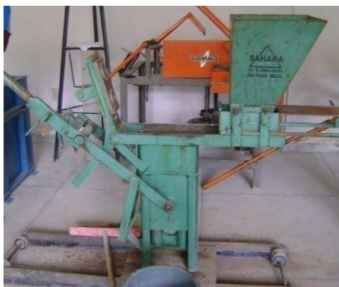
Figura 3.10: Prensa manual modular SAHARA, Desmoldagem de Tijolo de solo-cimento com resíduo granítico.
