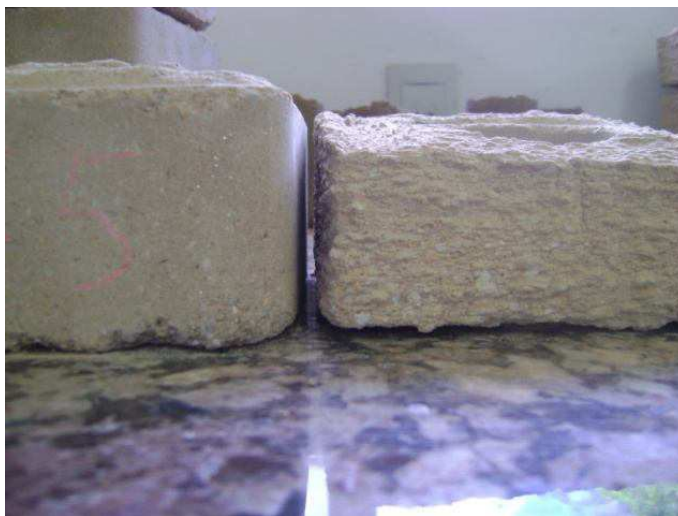
Figura 4.25: Desgaste dos tijolos de solo-cimento incorporados com resíduo de granito após a escovação, durante o ensaio de durabilidade.
