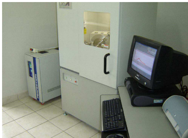
Figura 3.7: Equipamento XRD 6000 da Shimadzu para difração de raios-X.
