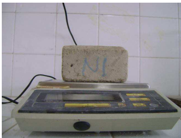
Figura 3.12: Pesagem dos tijolos em balança digital de precisão de 0,1g.
