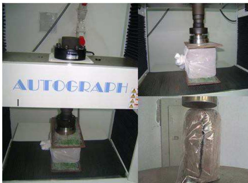
Figura 3.13: Ensaio de resistência a compressão simples em tijolo e corpo-de-prova cilíndrico solo-cimento.
