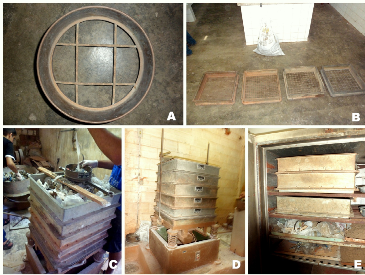
Figura 21 - A= Peneira Circular #76,2 mm; B= Série de peneiras retangulares; C= Resíduos submetidos ao peneiramento; D= Peneiramento sob agitação mecânica e E= Resíduos encaminhados para a estufa.
