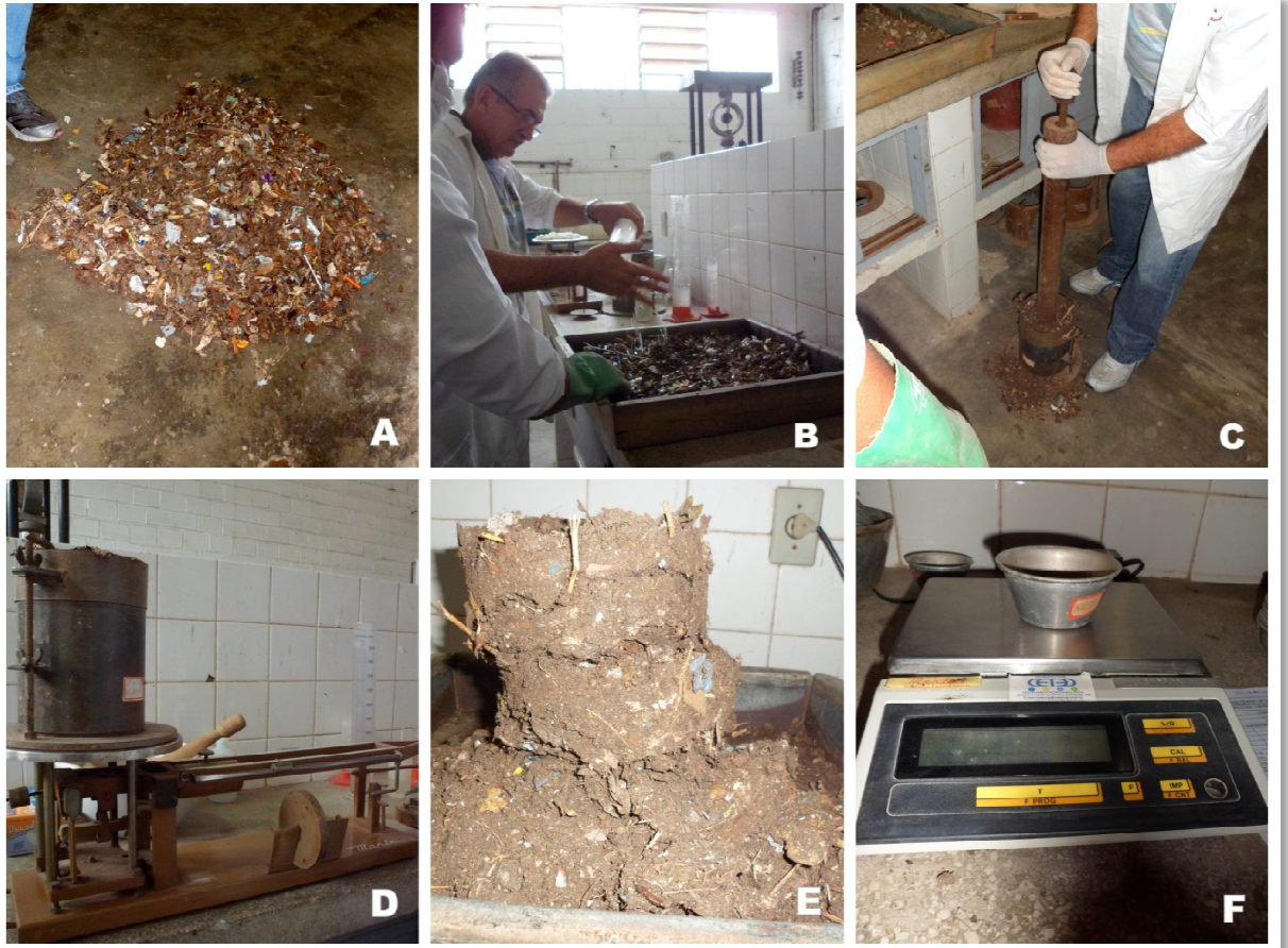
Figura 23 - A= Amostras passantes na peneira #19mm; B= Acréscimo da porcentagem adequada de água; C= Golpes da compactação; D= Pesagem do cilindro compactado; E=Desmolde de um do pontos do ensaio e F= pesagem para obter a umidade.
