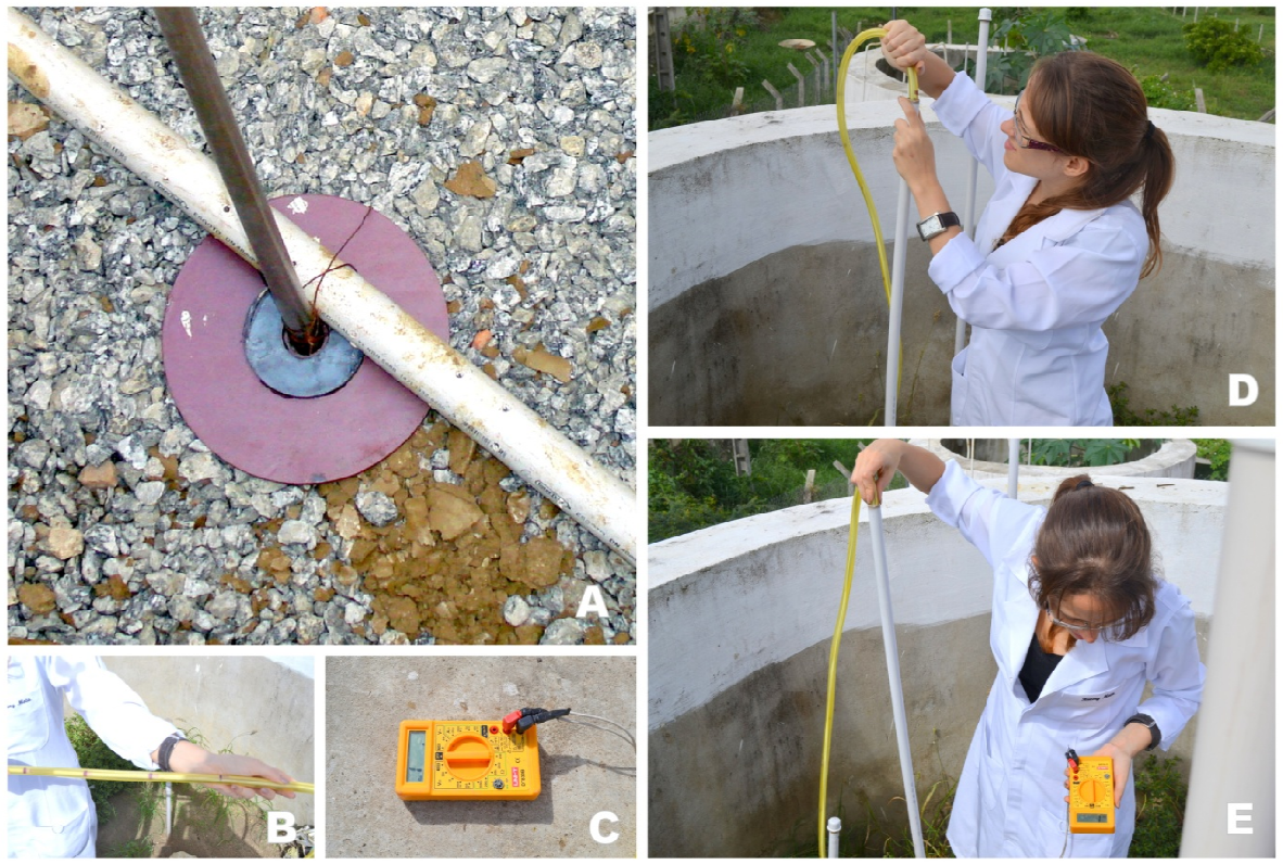
Figura 26 - A= Placa de recalque em profundidade; B= Mangueira graduada com sensor na ponta; C= Ohmímetro; D=Inserção do sensor magnético no tubo PVC e E=Identificação da profundidade da placa.
