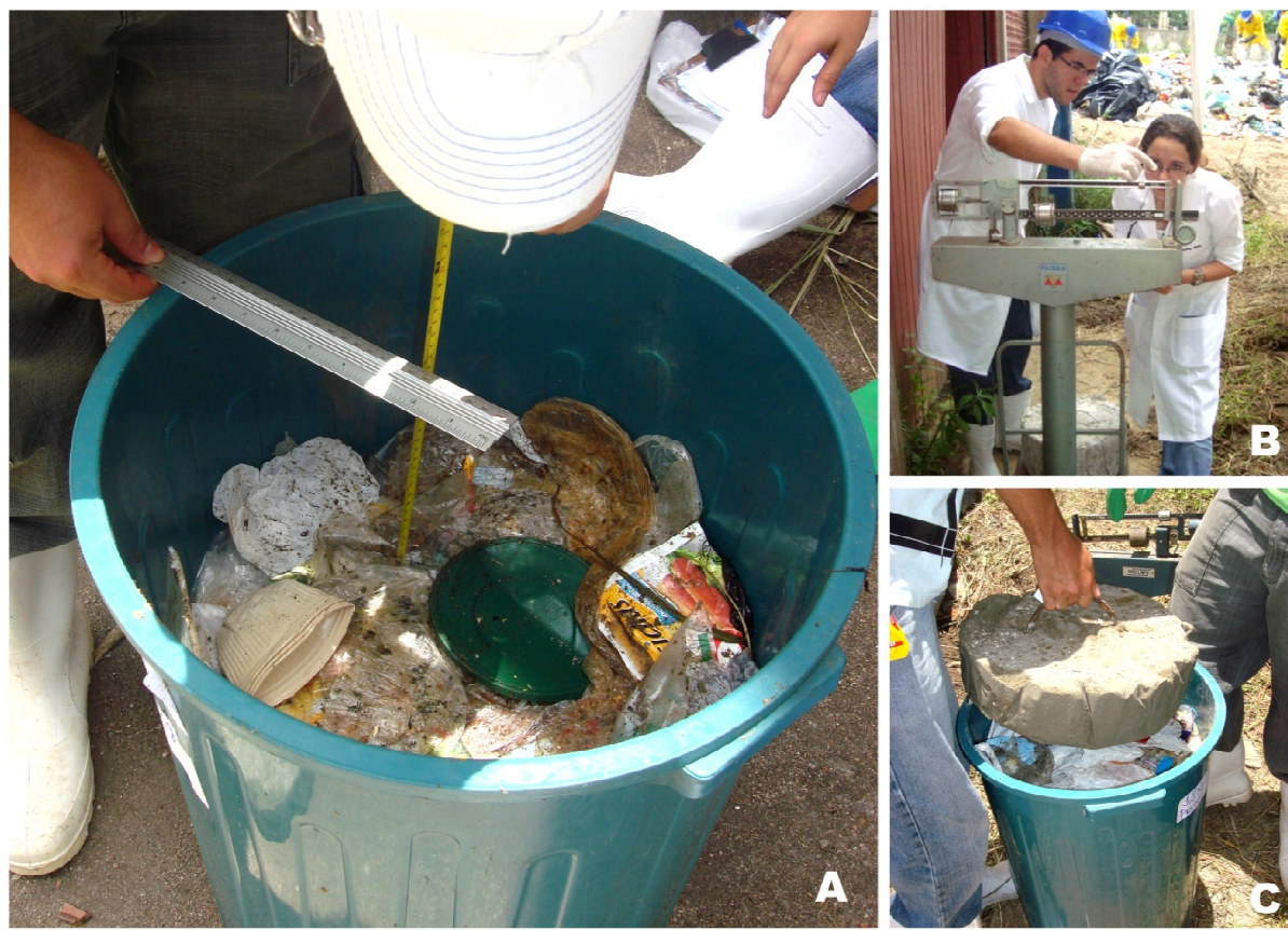
Figura 19 - A= Medição de altura e diâmetro ocupado pelos resíduos; B= Pesagem do soquete e C= Aplicação do carregamento.
