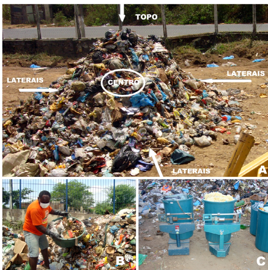
Figura 17 - A= Locais de retiradas da amostra; B= Resíduos para composição e C=Pesagem do material.
