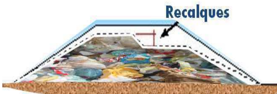
Figura 6 - Desenho esquemático do recalque em uma Célula de RSU (linha pontilhada).
