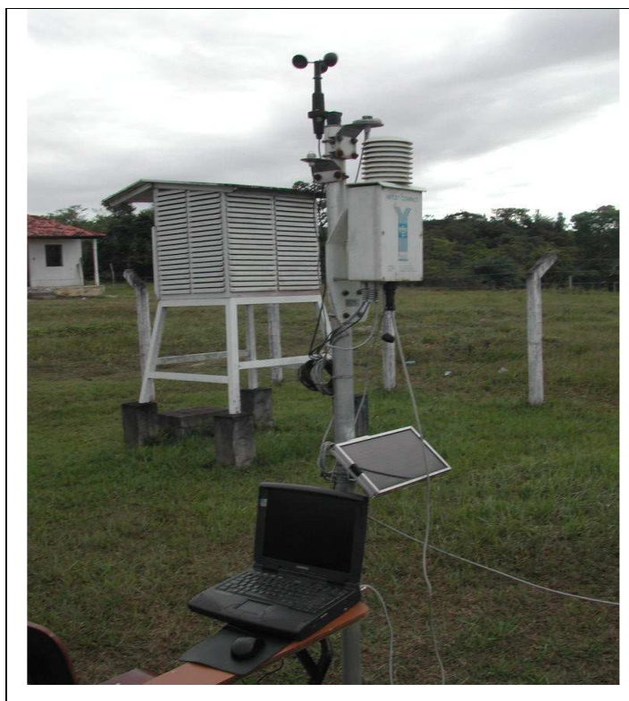
Figura 3 – Coleta de dados na estação Agrometeorológica automatizada do Campus Experimental da UFS para fins de irrigação.
