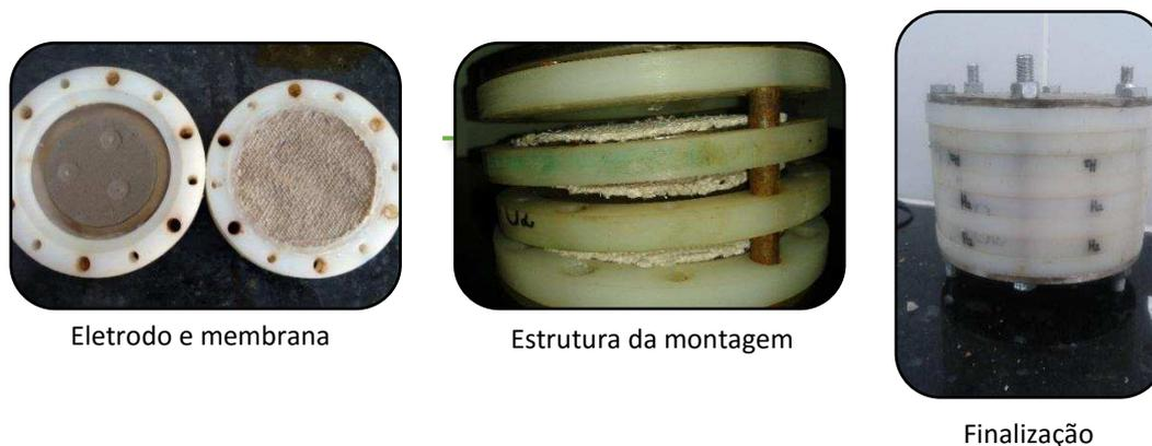
*Figura 22: Montagem do reator eletrolítico.*
