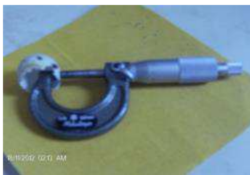
Figura 4 – Determinação da espessura de casca
