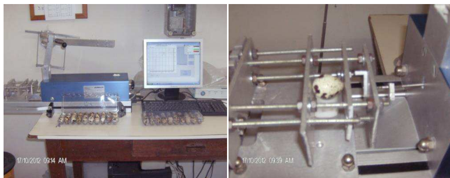
Figura 6 – Determinação da resistência de casca do ovo
