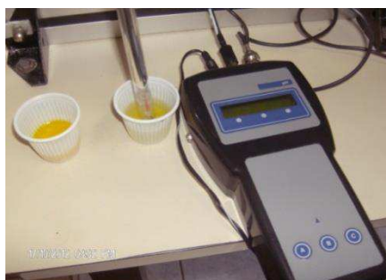
Figura 5 – Determinação do pH do ovo
