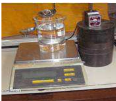
Figura 3 – Determinação da gravidade específica
