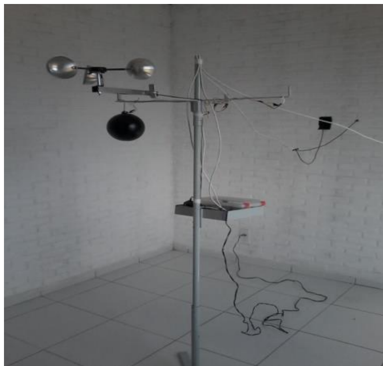
Figura 4. Estação meteorológica composto de arduino tipo Mega e sensores para obtenção e dados de temperatura, umidade e velocidade do vento.
