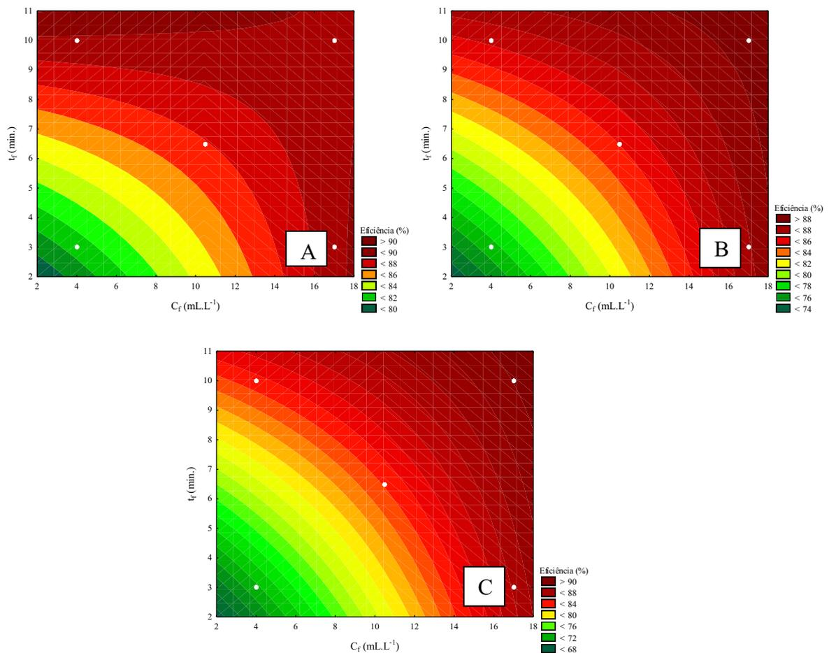
Figura 7. Curva de contorno para eficiência de remoção de óleos e graxas com tempo de mistura lenta para 3 minutos (A), 6,5 minutos (B) e 10 minutos (C) para floculante comercial.
