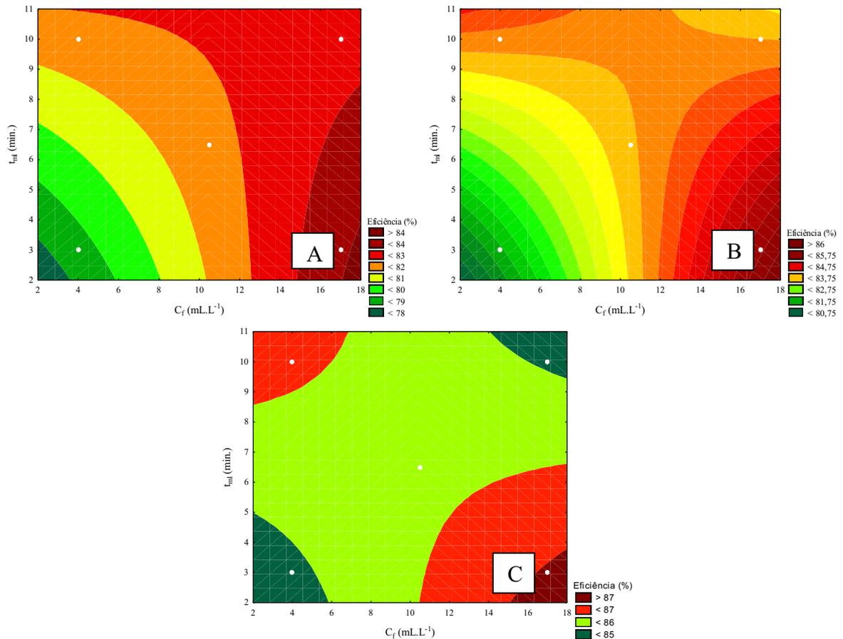
Figura 6. Curvas de contorno para eficiência de remoção de óleos e graxas com tempo de flotação para 3 minutos (A), 6,5 minutos (B) e 10 minutos (C) para o floculante concentrado de proteínas (F1).
