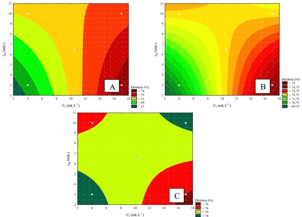
Figura 4. Curvas de contorno para eficiência de remoção de óleos e graxas com tempo de flotação de 3 minutos (A), 6,5 minutos (B) e 10 minutos (C) para o floculante extrato bruto (EB).
