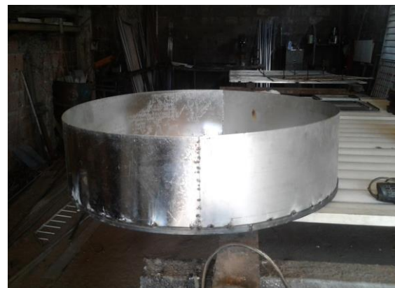
Figura 1. Tanque sendo confeccionado, parte externa.
