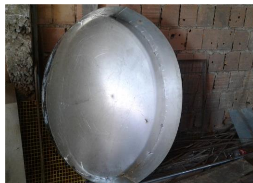
Figura 2. Tanque sendo confeccionado, parte interna.
