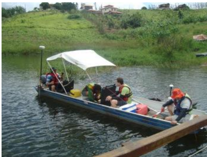
Figura 5. Barco equipado com GPS de precisão e Ecobatímetro para realização dos trabalhos de campo.
