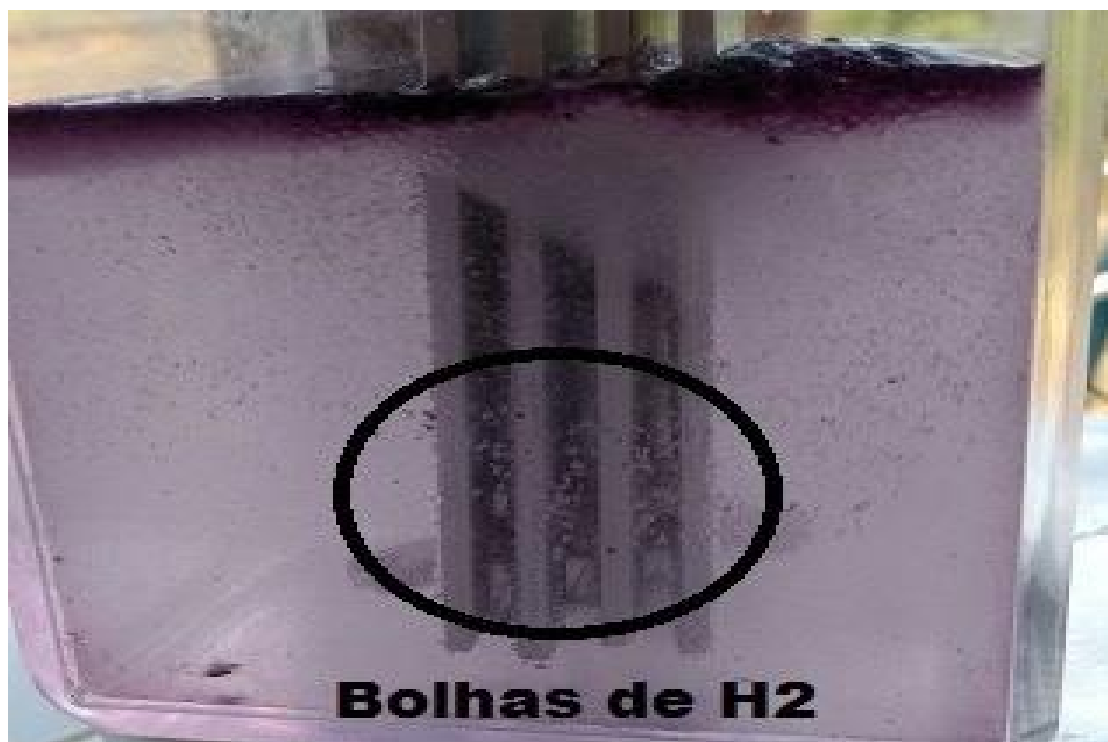
Figura 5. Observação da formação de bolhas de H 2 durante o processo de tratamento.
