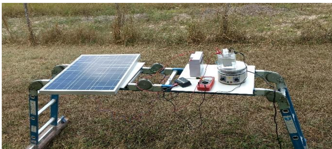
Figura 3. Montagem do sistema de eletrocoagulação/flotação usando fonte fotovoltaica de energia.
