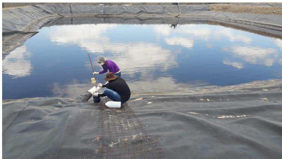
Após a coleta encaminhou-se parte do volume de lixiviado para a caracterização físico-química no Laboratório de Geotecnia Ambiental (LGA) da UFCG. Do lixiviado foram obtidos os seguintes parâmetros: pH, alcalinidade total, sólidos totais e voláteis, cloretos, DQO, DBO, nitrogênio amoniacal. Estas análises seguiram a metodologia descrita na *Standard Methods for the Examination of Water and Wastewater* (APHA, 2017).
