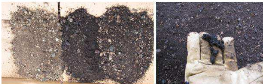
Figura 6 - Evidência de ativação do ligante do RAP e aglomeração de partículas finas de RAP em uma usina das Estradas do Condado de Minnesota
