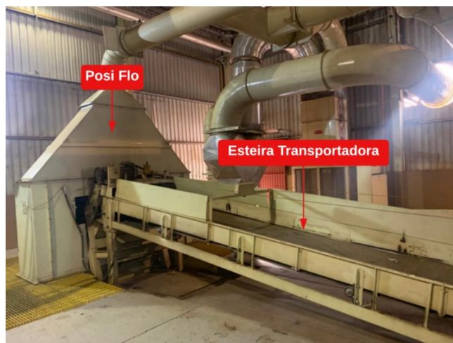
Figura 16 – Esteira transportadora e Posi Flo.
