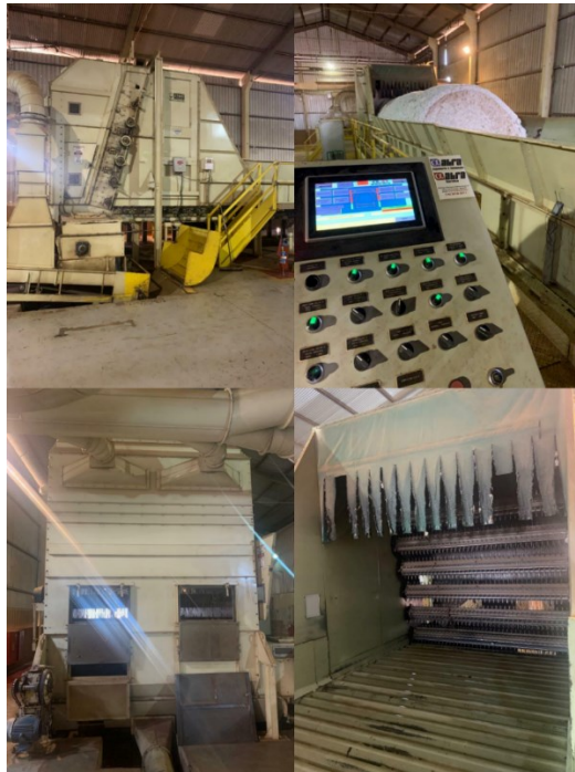
Figura 15 – Abridor de módulos.
