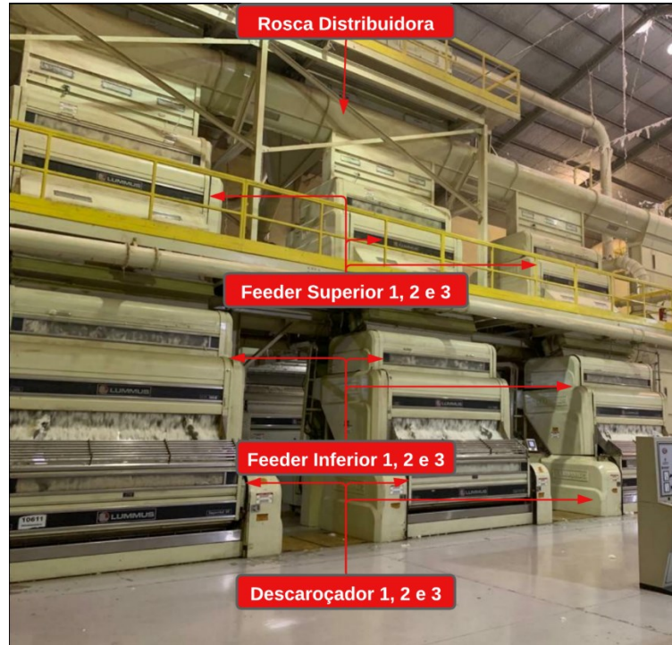
Figura 20 – Rosca distribuidora, descaroadores, feeders superiores e inferiores.
