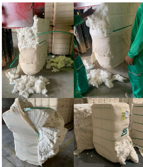
Figura 44 – Fardos com fitas e saco tela rompidos.
