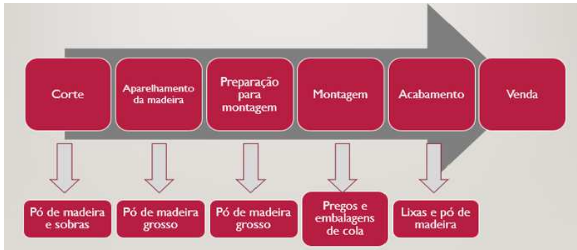
Figura 2: Esquema de produção da empresa Ax com resíduos gerados em cada etapa
