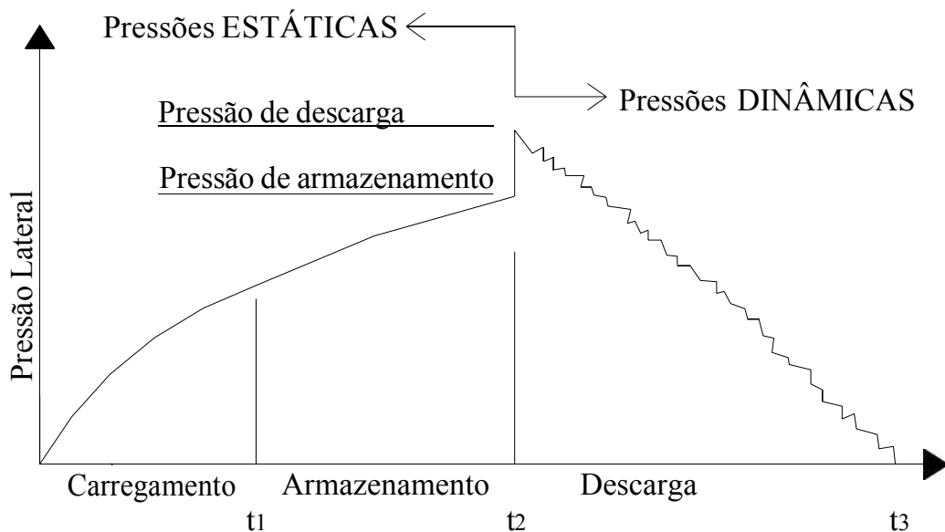
Figura 15. Pressões atuantes nas paredes do silo nas fases de carregamento, armazenamento e descarga. Fonte: Deckers (2014).
