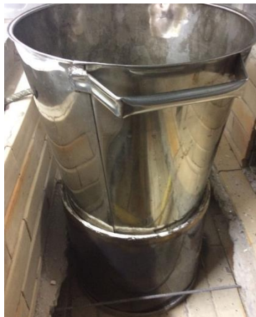
Figura 3 - Reator utilizado na reação de combustão para a obtenção da \text{CoFe}_2\text{O}_4
