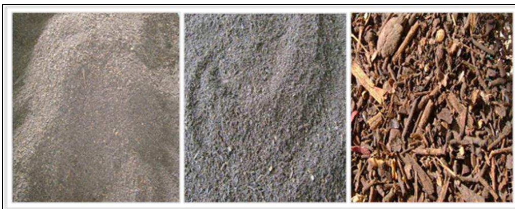
Figura 2.07: Compostos tipo pó e farelo e o rejeito originado da co-compostagem de lodos de tanques sépticos coletivos e resíduos sólidos orgânicos domiciliares. Campina Grande-PB. Novembro de 2006 a fevereiro de 2007.
