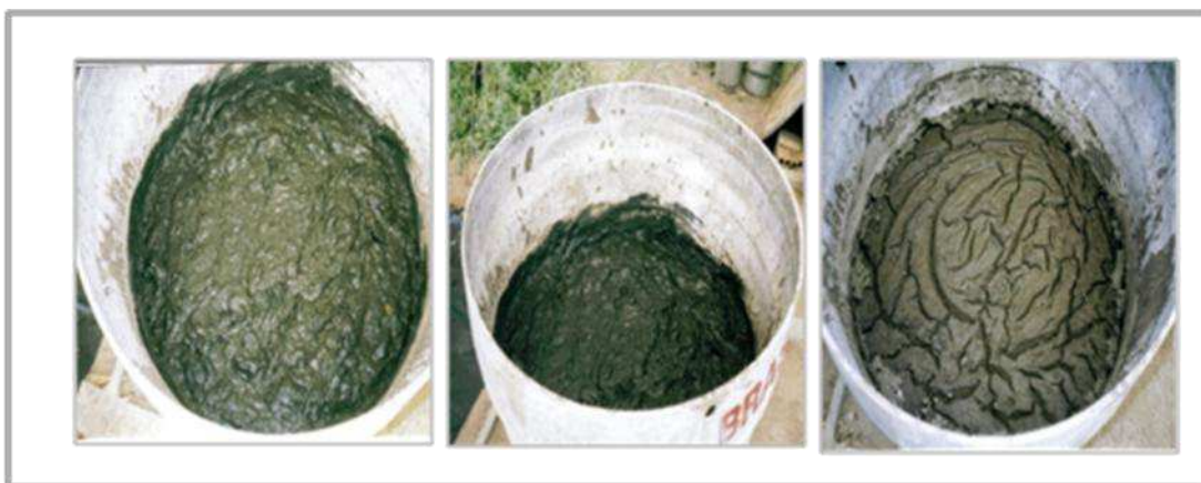
Figura 2.05: Condições de secagem dos lodos coletados nos tanques sépticos coletivos de Cabaceiras e Caraúbas, Paraíba. Setembro a outubro de 2006.
