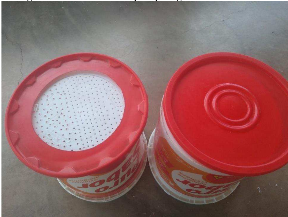
Figura 04: Baldes com furos para passagem do chorume.
