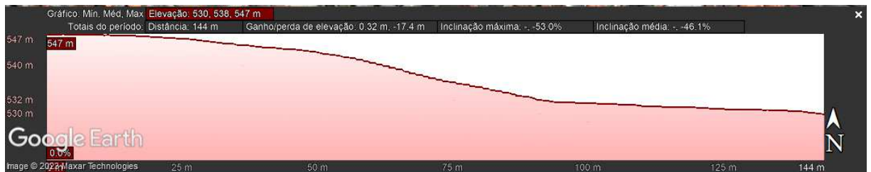
Figura 09 – Perfil longitudinal da Rua São Jacinto.
