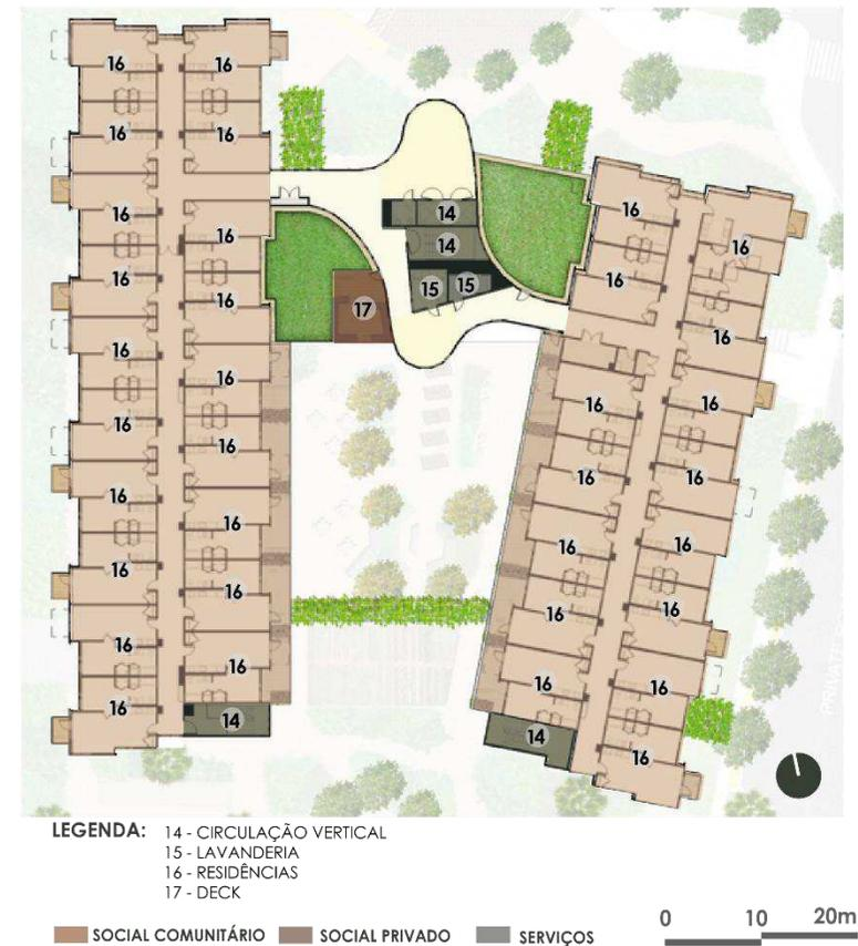
**FIGURA 15:** Planta baixa zoneada - Pavimento tipo.
