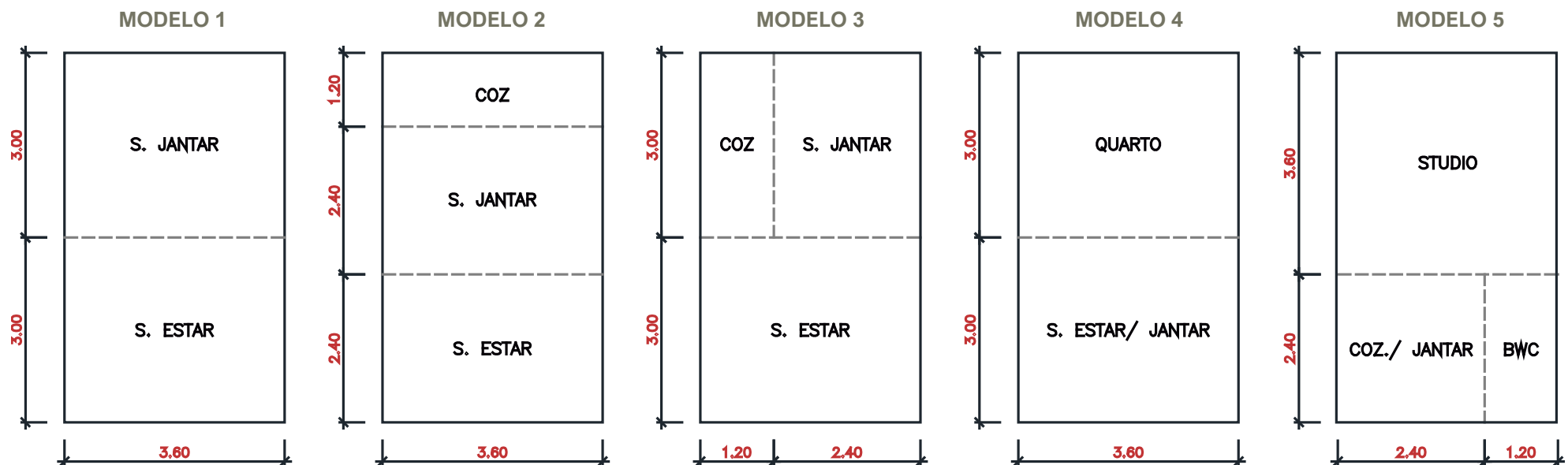
Figura 3.10: Divisão espacial interna nos módulos 1. Fonte: Autor 2022.
