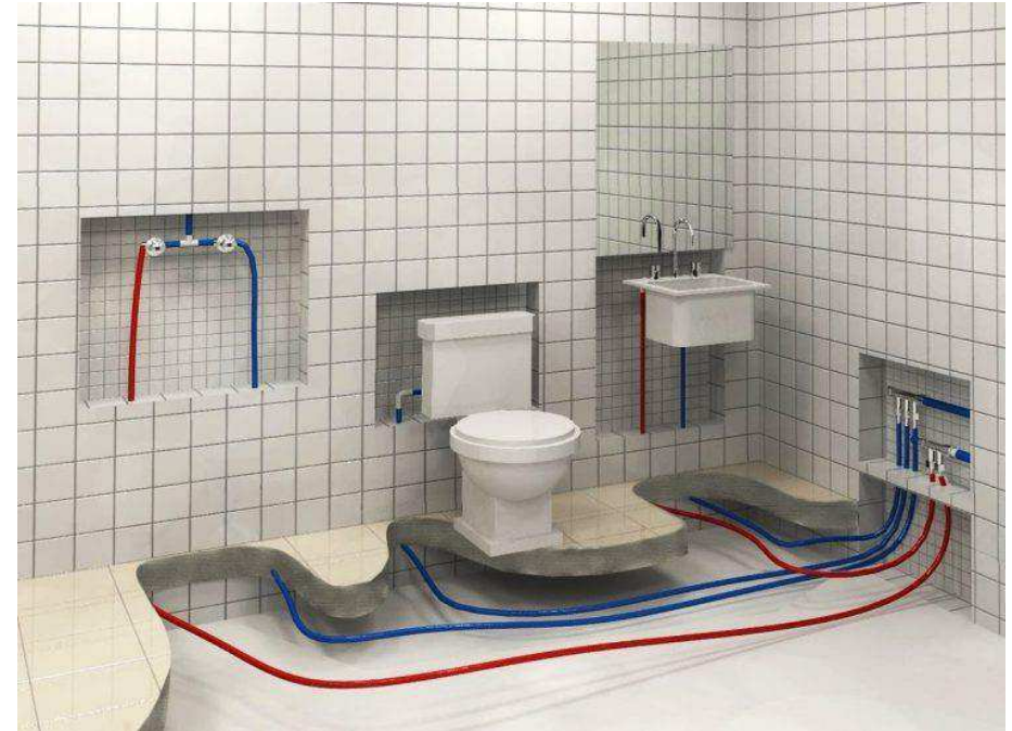
Figura 1.6: Instalações tipo “PEX”. Fonte: lightsteelframe.eng.br.
