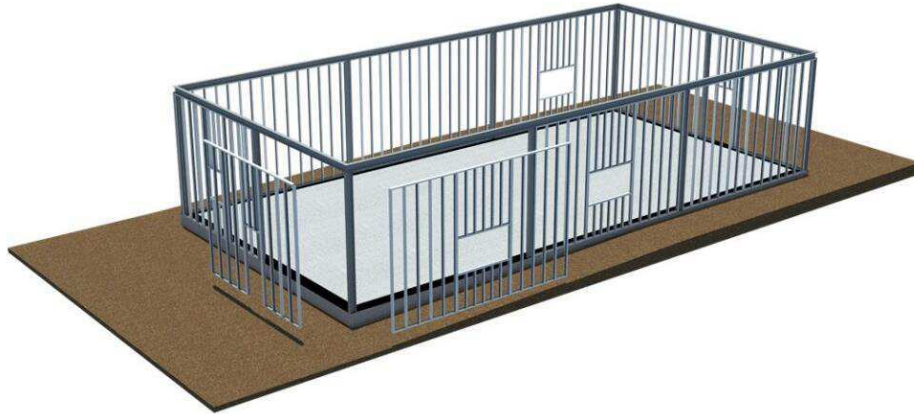
Figura 1.4: Montagem dos painéis. Fonte: construindocasas.cm.br 2022.
