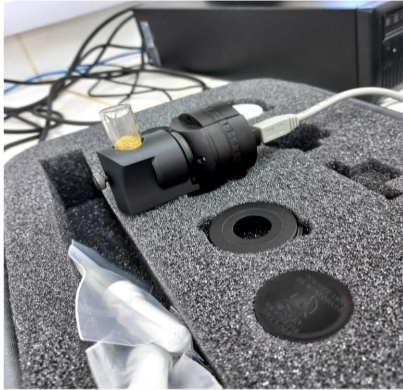
Fotografia 4 – Amostra em “vial” já inserido no MicroNir para análise.
