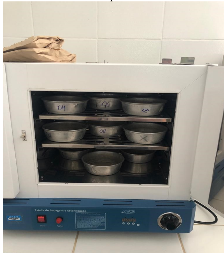
Figura 6 - Secagem das amostras em estufa de circulação de ar par obtenção da massa de sedimentos para amostras.
