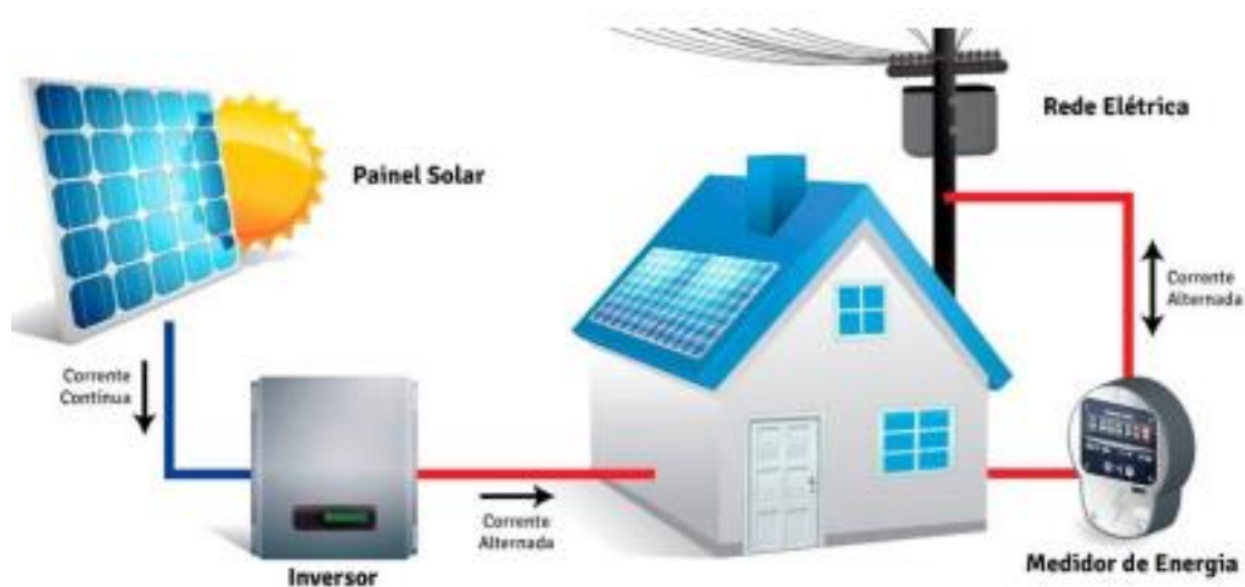
Figura 5 – Sistema solar conectado à rede on-grid.
