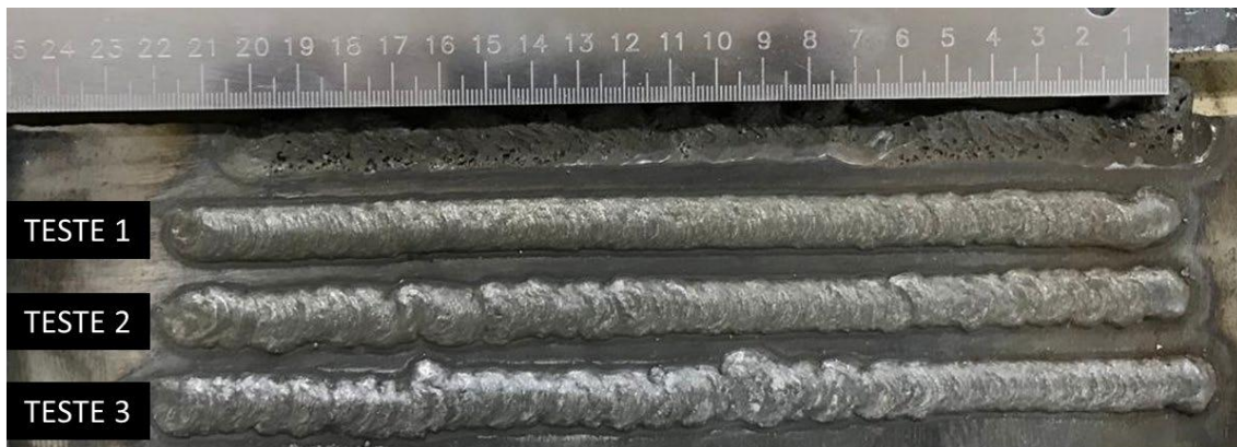
Figura 35 - Testes variando apenas a angulação do eletrodo.
