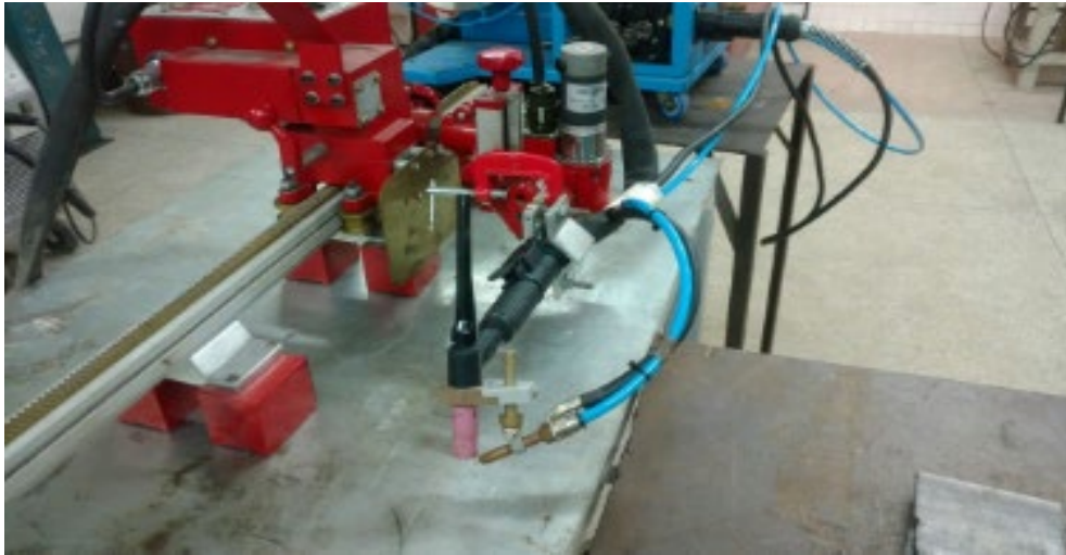
Figura 27 - Tocha GTAW acoplada ao trator de soldagem.
