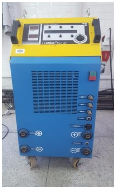
Figura 25 - Fonte de soldagem multiprocesso DIGIPlus A7.
