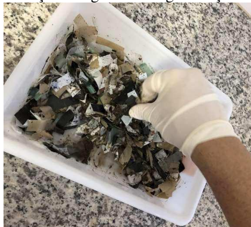
Figura 32 – Adição de água e homogeneização dos materiais
