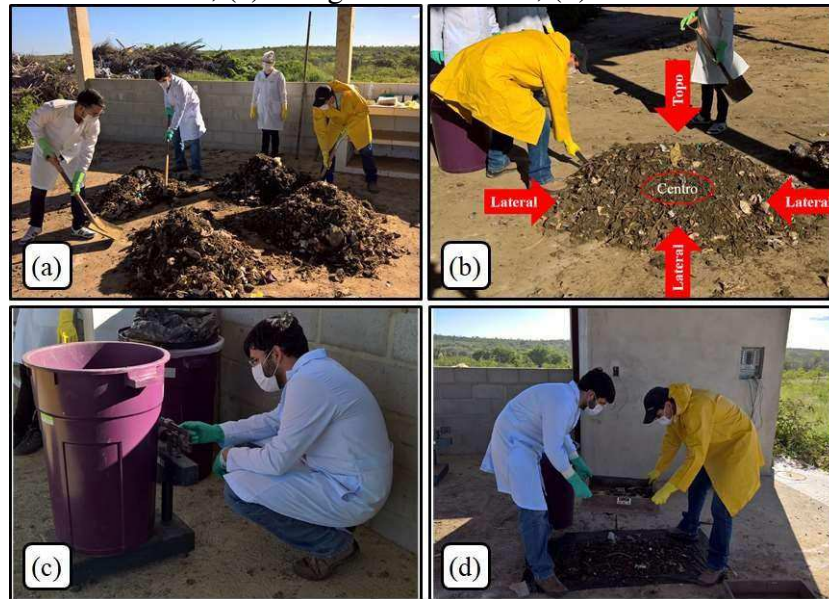
Figura 22 – (a) Quarteamento do material misto; (b) Coleta do material do topo, das laterais e do centro; (c) Pesagem do material; (d) Peneiramento
