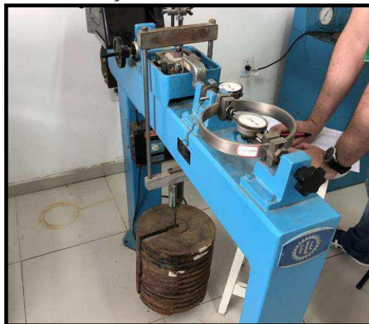
Figura 40 – Realização do ensaio de cisalhamento direto
