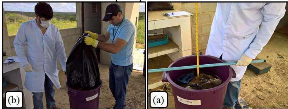
Figura 23 - (a) Resíduos sendo colocados nos baldes; (b) Medição da altura e diâmetro ocupados pelos resíduos
