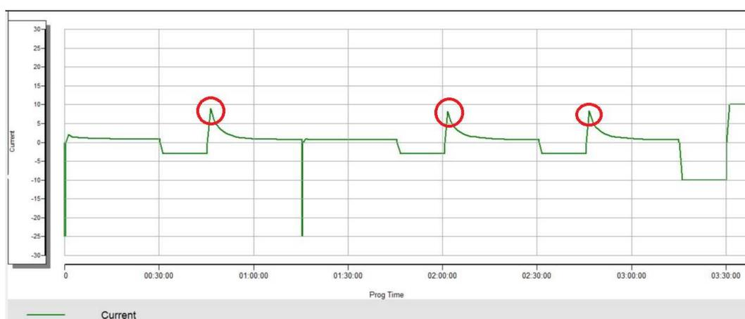
Figura 6.8: Medição de corrente segundo a norma ABNT 15904. Corrente x Tempo.
