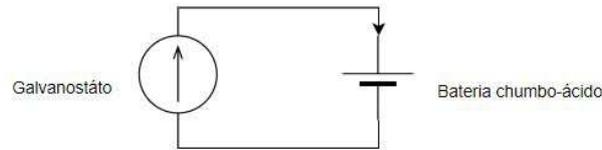
Figura 2.8: Diagrama elétrico para espectroscopia de impedância.
