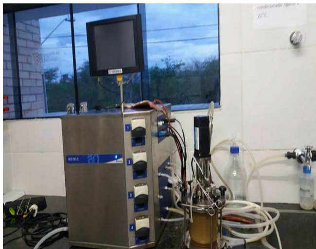
FIGURA 1—REATOR UTILIZADO NO PROCESSO FERMENTATIVO COM AGITAÇÃO
