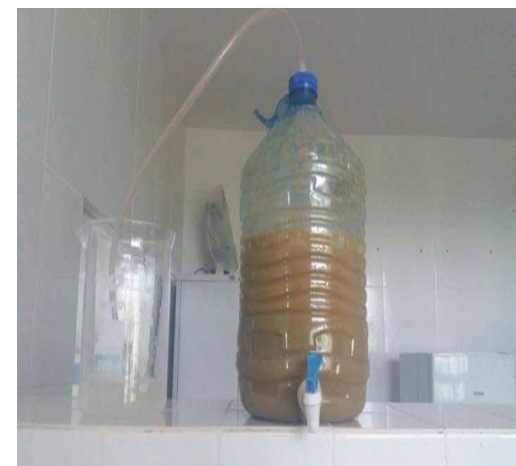
FIGURA 2—REATOR UTILIZADO NO PROCESSO FERMENTATIVO SEM AGITAÇÃO
