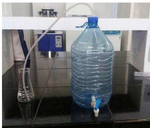
FIGURA 2 —REATOR UTILIZADO NO PROCESSO FERMENTATIVO SEM AGITAÇÃO
